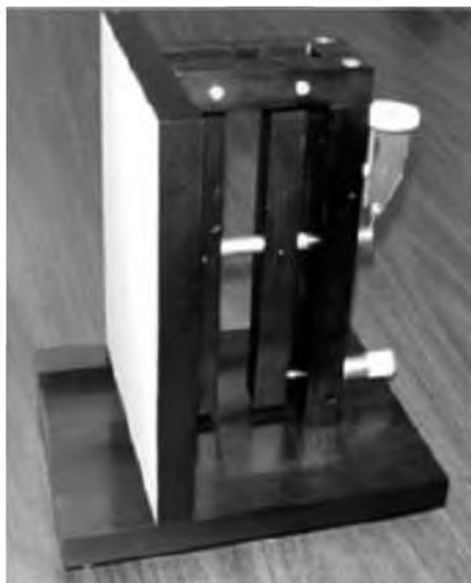
Рисунок 9 — Устройство для калибровки камеры для шерографии включает в себя средство для нанесения за меренного значения деформации по отношению к плоскому алюминиевому листу. Деформация плоской поверхности подвергается съемке. Такое устройство позволяет поверить работу камеры для шерографии, стабильность лазерного излучения, а также минимальную когерентную длину
