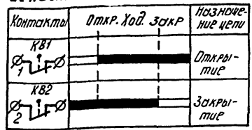
Диаграмма замыкания контактов конечных выключателей исполнительного механизма ИМ
