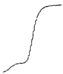
Рис. Полярографическая волна восстановления
