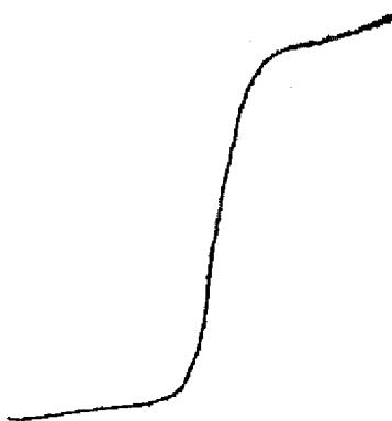
Рис. Полярографическая волна восстановления цинка в хлоридно-аммиачном растворе.
