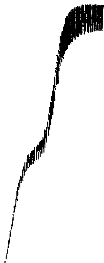
Рис. 4. Полярографическая волна восстановления меди в сульфатно-аммиачном растворе. Концентрация меди 0,5 мг/мл
