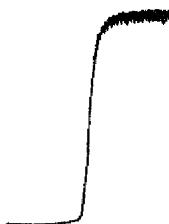
Рис. 3. Полярографическая волна восстановления свинца в ацетатном растворе. Концентрация свинца 0,5 мг/мл
