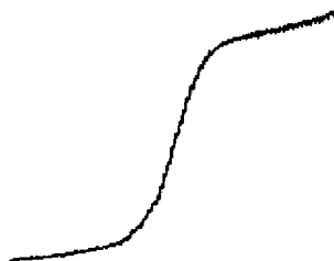
Рис. I. Полярографическая волна восстановления германия IV в карбонатно-комплексном растворе. Концентрация германия IV - 20 мкг/мл.
