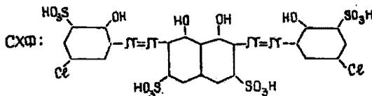
Раствор реагента имеет фиолетовую окраску. При комнатной температуре реакция протекает медленно (1 час и более), при нагревании значительно быстрее. Окраска раствора после полного ее развития устойчива в течение нескольких часов. Реакция проходит как в водной, так и в водно-ацетоновой среде. В водно-ацетоновой среде окраска несколько интенсивнее и устойчивее. Реакция идет в растворе 2 н по соляной кислоте, в присутствии виннокислого аммония и ацетона.
