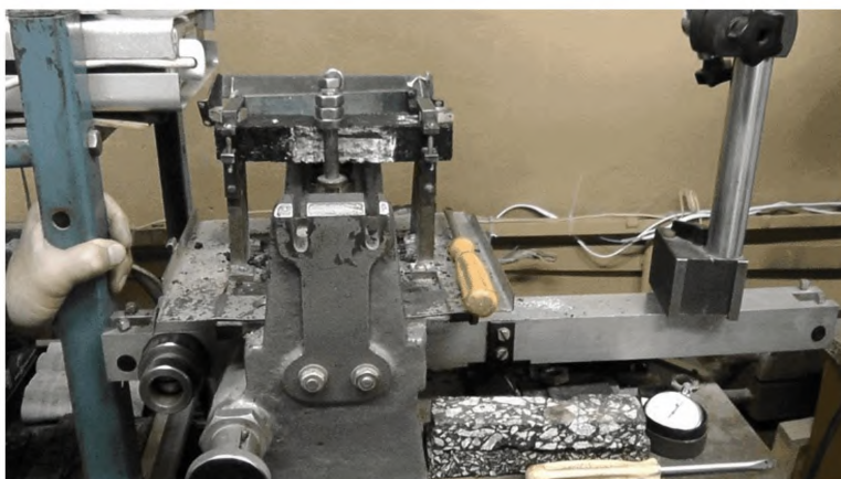
Рисунок Г.6 – Прибор ФР-2 (флексометр), позволяющий проводить испытания образцов асфальтобетона на усталость при изгибе с целью оценки усталостной долговечности в лабораторных условиях
