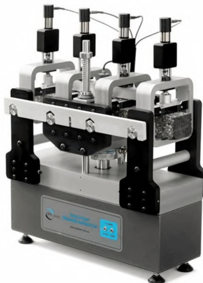
Рисунок Г.5 -Приспособление для испытаний на усталостную долговечность при 4-х точечном изгибе асфальтобетонных покрытий
