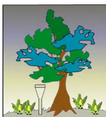
Рисунок А.5 – Место размещения осадкомера при классе 5
