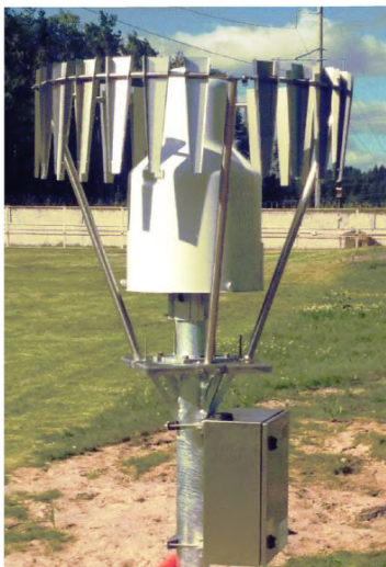
Рисунок 1 – Осадкомер ОТТ Pluvio 2 200 в ветровой защите Альтера
