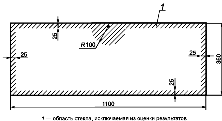
Рисунок 19 — Область, исключаемая из определения количества осколков и максимальных осколков
