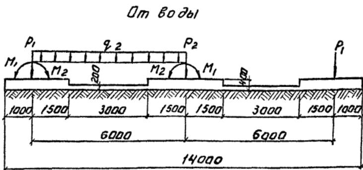
Расчетные схемы единиц резервуаров приема осадка
