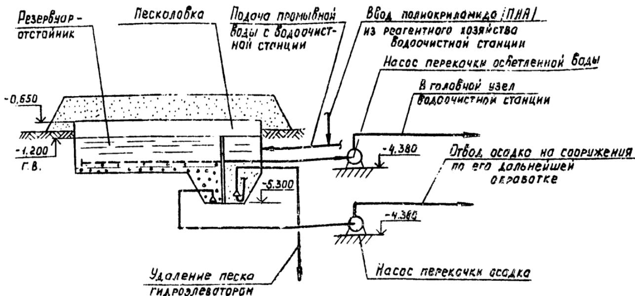
Исходя из приема объема воды от промывки одного контактного советлиителя и ее часового отстаивания ёмкость каждого резервуара принята:
