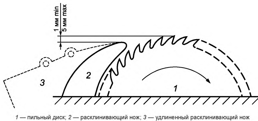
Рисунок 106 — Пределы высоты кончика раскливающего ножа
