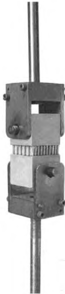
Рисунок 1 — Приспособление для нагружения для определения предела прочности на растяжение перпендикулярно к плоскости «сэндвич»-конструкций
