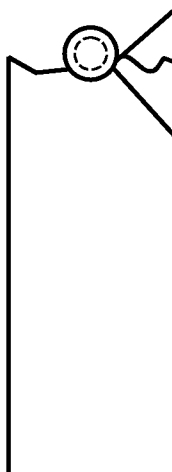
Рисунок Г.15 — Разрушение при сжатии типа MGF: многотиповое разрушение крепления, гайки, шайбы
