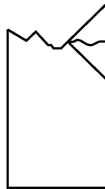
Рисунок Г.8 — Разрушение при растяжении типа MGM: многотиповое разрушение через центр отверстия (сопровождается деламинацией и разделением на части)
