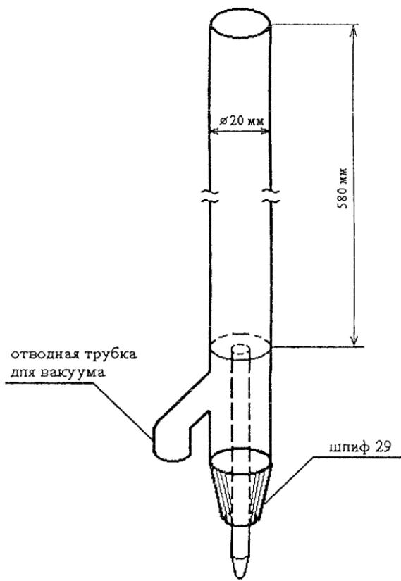
Рис. 1. Колонка для концентрирования.
