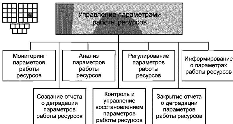
Рисунок 3 — Декомпозиция процесса 1.1.3.4 — «Управление параметрами работы ресурсов» на элементы процессов уровня 3
