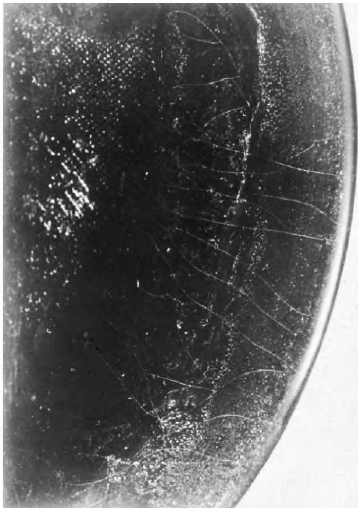
Рисунок А.2 — Волосяная трещина
