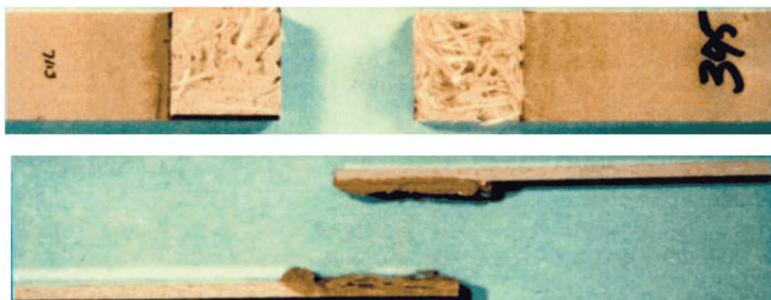
Рисунок А.13 — Разрушение из-за разрыва волокон
