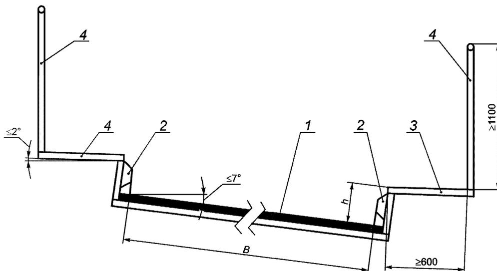
1 — рабочая поверхность; 2 — ограничительная система; 3 — трап; 4 — ограждение
