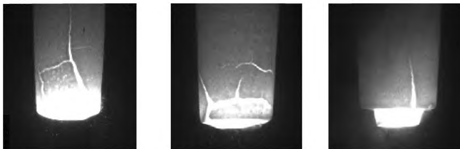
Рисунок 14 — Типичные случаи трещинообразования торцов электродов в случаях экстремального увеличения подводимой мощности
