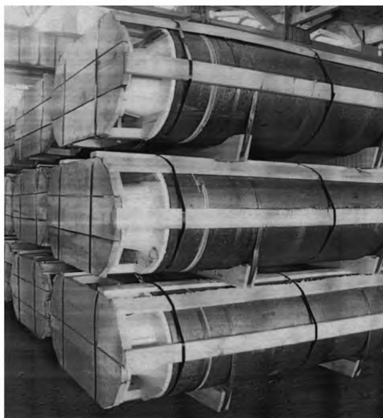
Рисунок 1 — Общий вид упакованных электродов с вкрученными ниппелями
