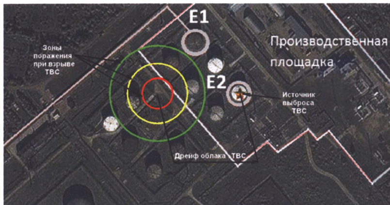
Рис. 1. Зоны поражения ударной волной при взрыве облака ТВС
