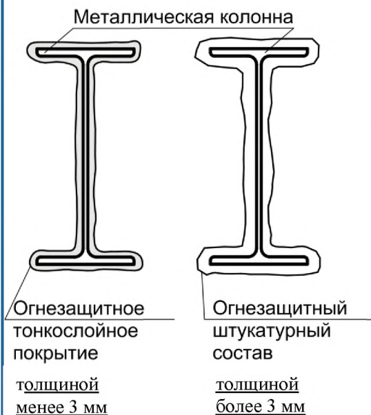
Металлическая колонна в огнезащитном покрытии
