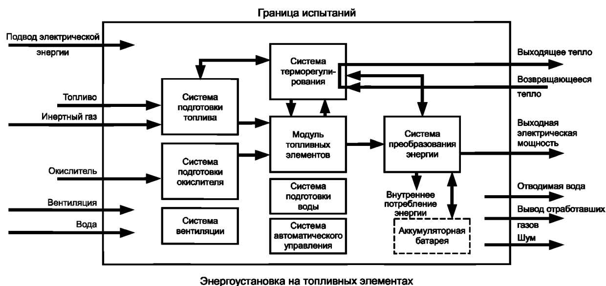
Рисунок 2 — Общая структура стационарной энергоустановки на топливных элементах малой мощности
