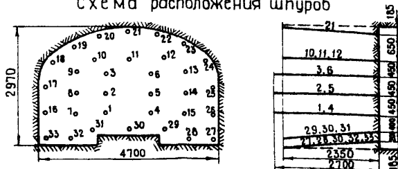
Схема расположения шпуров
