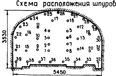
Схема расположения шпуров
