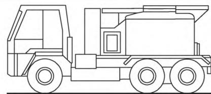
Рисунок 8 — Мобильный комплекс оборудования с функциями подогрева и плавки битумной смеси
