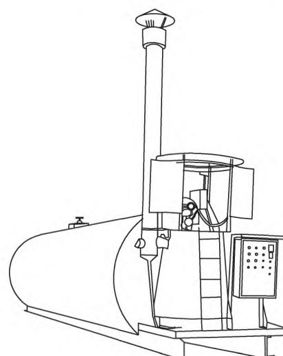
Рисунок 9 — Резервуар для хранения битумных смесей
