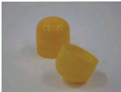
Рисунок А.5 — Пример несоответствия упаковки цилиндрической формы со скругленными концами
