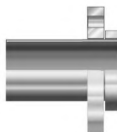
Рисунок 11 - Фланцевое соединение с припаянным плоским кольцом из литейной бронзы и подвижным стальным фланцем
