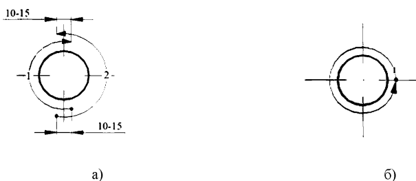
Рисунок 7 - Схема выполнения сварного неповоротного шва
