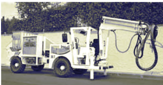
Рисунок А.18 – Малогабаритная торкрет-установка
