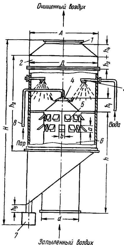
Рис. 58. Пароводянной пылеуловитель типа ПВП:
