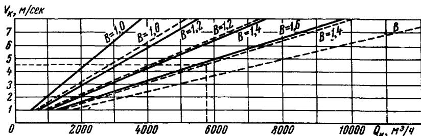
Рис. 29. График для определения объемов воздуха  $Q_h$ , просасываемого через неплотности укрытий конвейера, при подаче угля из бункеров через герметичные питатели, а также с конвейеров, питателей, грохотов, элеваторов и дробилок
