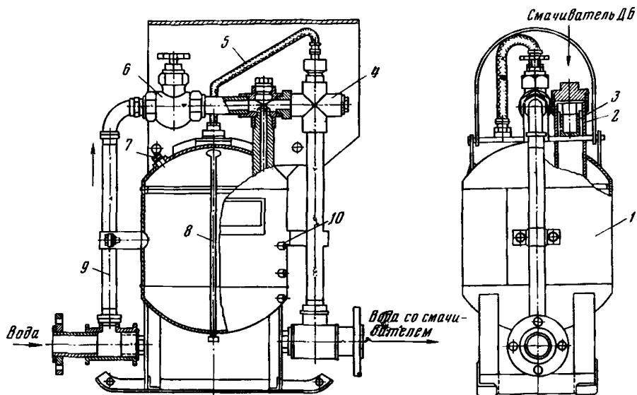
Рис. 36. Дозатор смачивателя типа ДСУ-3:
