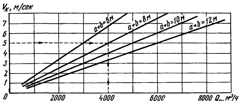
Рис. 30. График для определения объемов просасываемого через неплотности воздуха  $Q_h$  грохотов с укрытиями, установленными на раме
