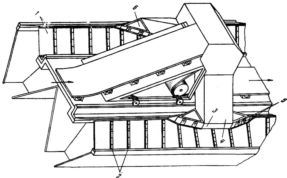
Рис. 19. Укрытие бункера (загрузка углем осуществляется с помощью конвейера со сбрасывающей тележкой):
