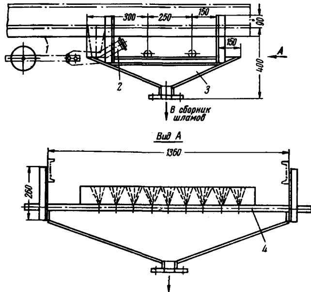
Рис. 7. Устройство для гидравлической очистки холостой ветви ленточного конвейера:
