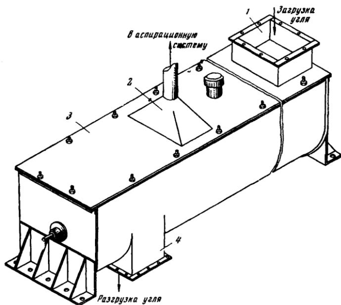
Рис. 23. Укрытие винтового конвейера (шнека):
