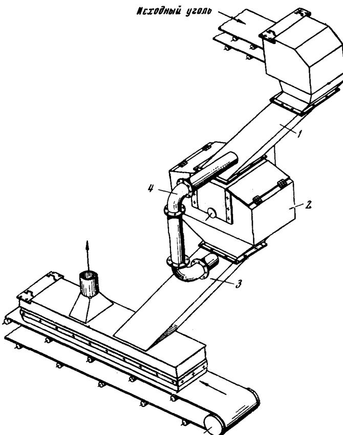
Рис. 15. Укрытие молотковой дробилки с обводными трубами, эксплуатируемое на асбестообогатительных фабриках:
