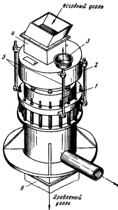
Рис. 16. Укрытие загрузочной части котротоконусной дробилки (укрытие аналогичного типа изготавливает Уралмаш- завод):
