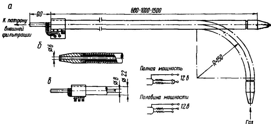
Рис. 63. Основные размеры заборной трубы и наконечника для определения запыленности воздуха в трубопроводе методом внешней фильтрации:
