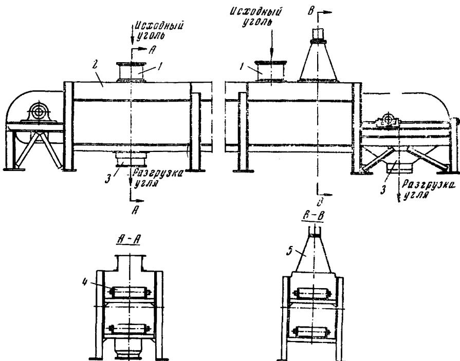
Рис. 20. Укрытие бункера при загрузке скребковым конвейером:
