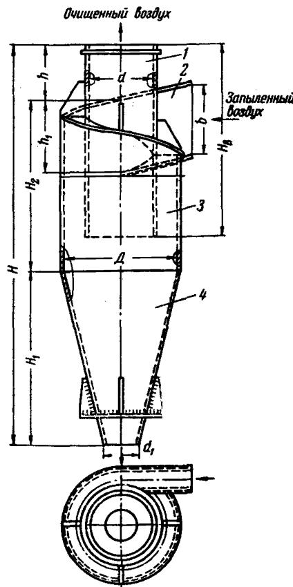
Рис. 48. Циклон НИИОГаз:
