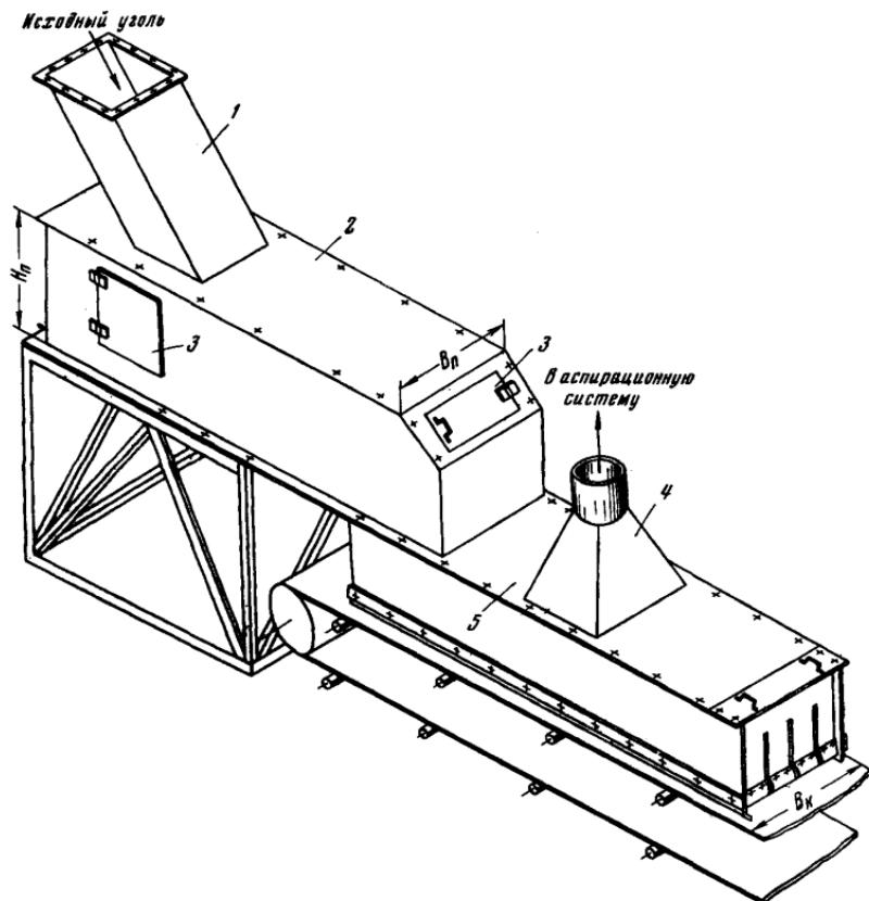
Рис. 3. Укрытие пластинчатого питателя:
