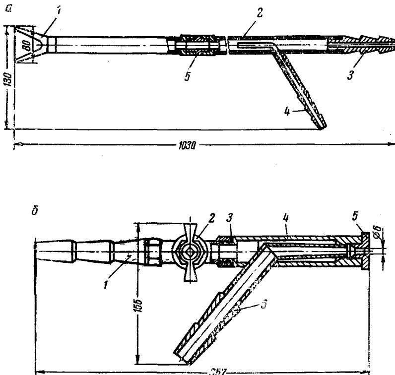
Рис. 39. Форсунки для уборки осевшей пыли:
