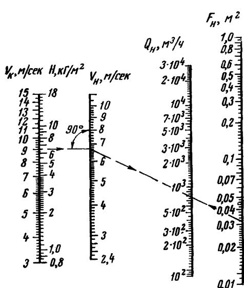
Рис. 25. Номограмма для определения объемов воздуха  $Q_H$ , просасываемого через неплотности укрытий конвейеров, бункеров, питателей
