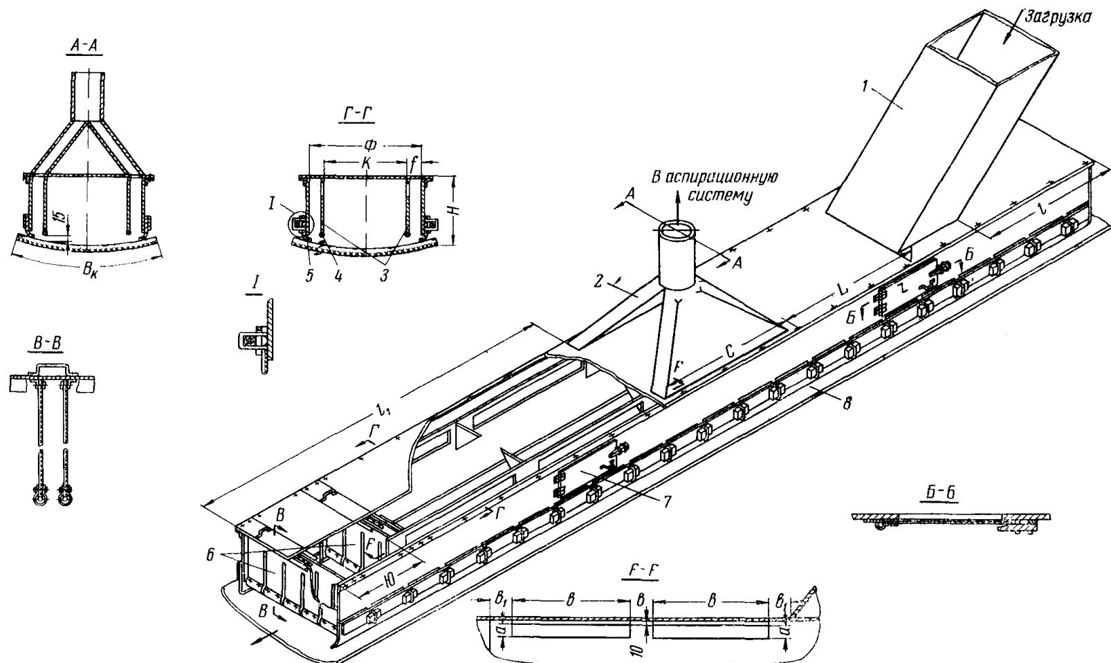
Рис. 9. Двойное укрытие ленточного конвейера, разработанное ВостНИИ:
