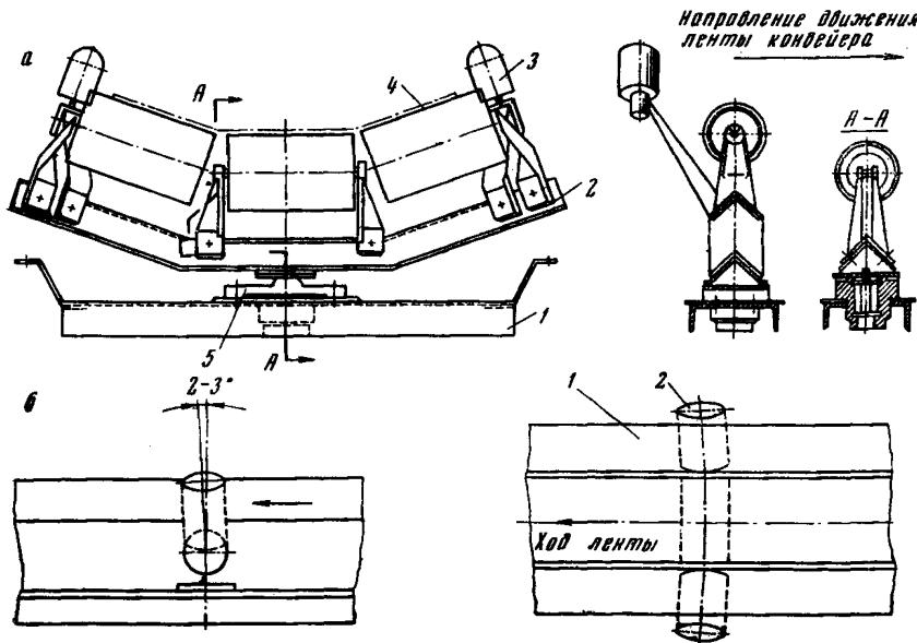
Рис. 5. Устройства для предотвращения схода лент конвейеров:
