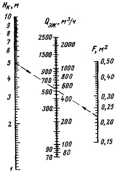
Рис. 26. Номограмма для определения объемов эжектируемого воздуха  $Q_{\text{эж}}$  для узлов перепада угля из циклонов на конвейер через разгрузочный патрубок с клапаном-мигалкой
