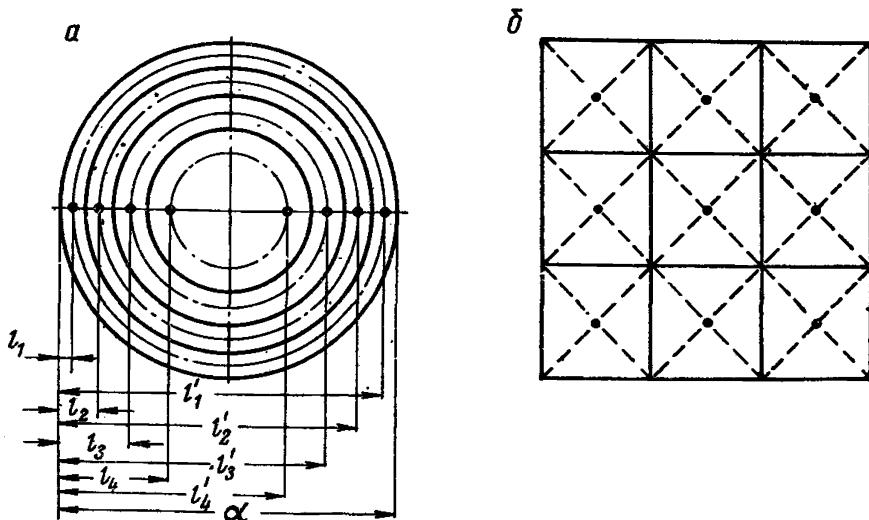
Рис. 61. Разбивка сечения воздуховодов при замерах пневмометрическими трубками:
