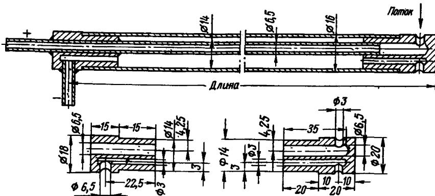
Рис. 60. Пневмометрическая трубка Гинцвейнта
