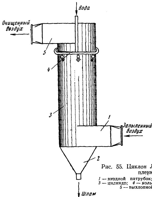
*Техническая характеристика циклонов ЛИОТ с водяной пленкой*
