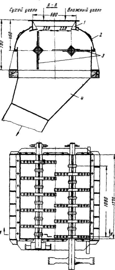
Рис. 1. Смеситель для сухих и влажных углей, рекомендуемый МакНИИ:
