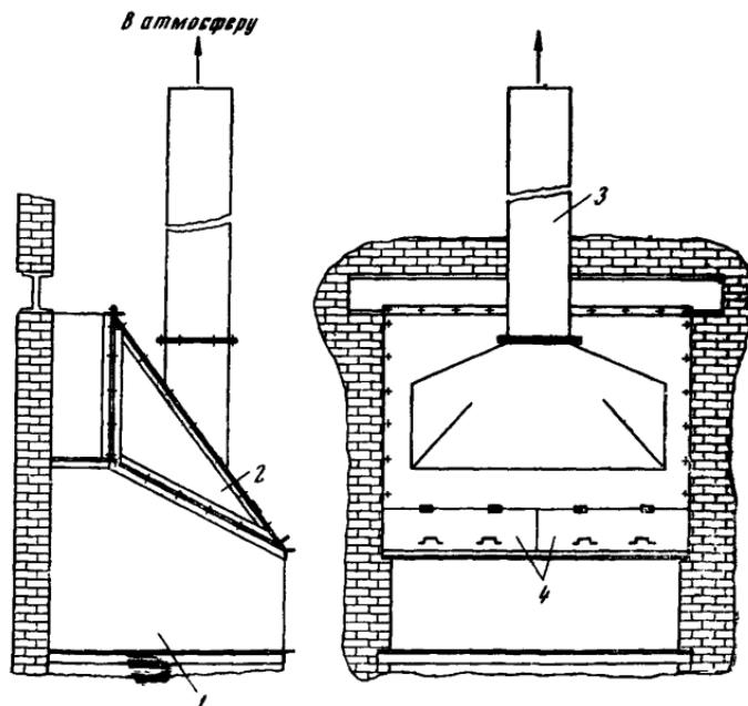
Рис. 21. Укрытие бункера при загрузке с помощью ската:
