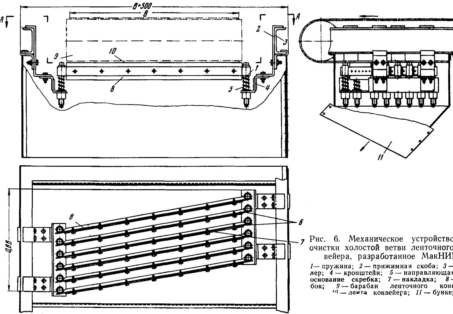
Рис. 6. Механическое устройство для очистки холостой ветви ленточного конвейера, разработанное МакНИИ:
