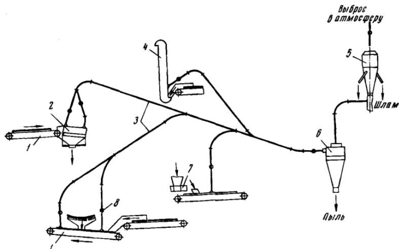
Рис. 33. Схема аспирационной установки:
