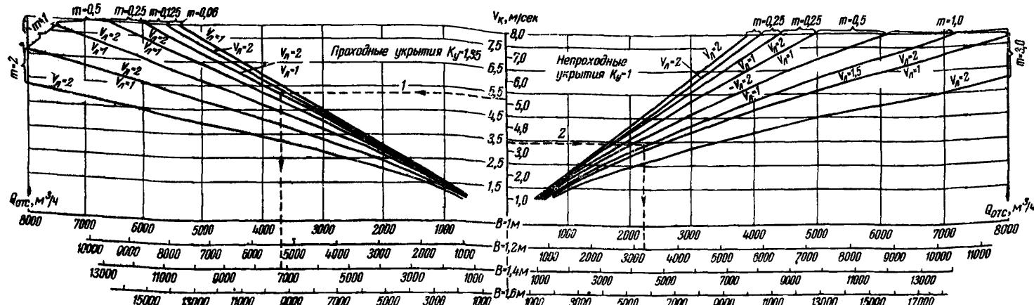
Рис. 46. Графики для определения объемов воздуха, аспирируемого из укрытий ленточных конвейеров при подаче материала через течки с конвейеров, питателей, из сепараторов, надрешетной части грохотов и валковых дробилок (по материалам Южгипрошахта)
