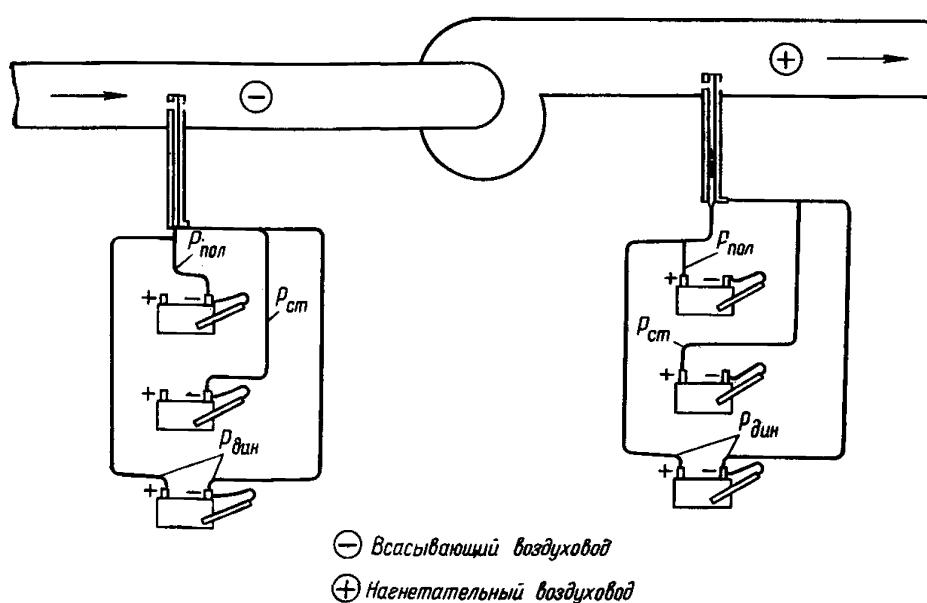
Рис. 62. Схемы подсоединения пневмометрической трубы к микроманометру для замеров динамического, статического и полного напоров
