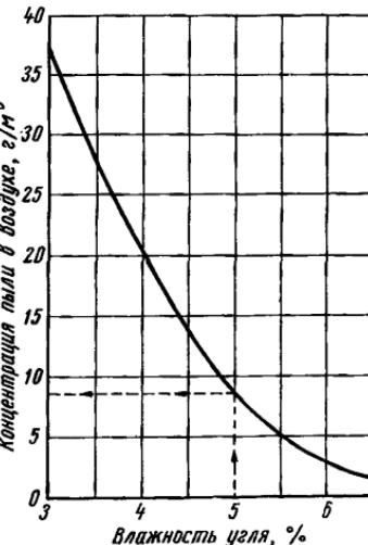
Рис. 31. График для определения запыленности отсасываемого из-под открытых воздуха (при влажности  $W > 6\%$ , при концентрации  $C = 2 \text{ г}/\text{м}^3$ )
