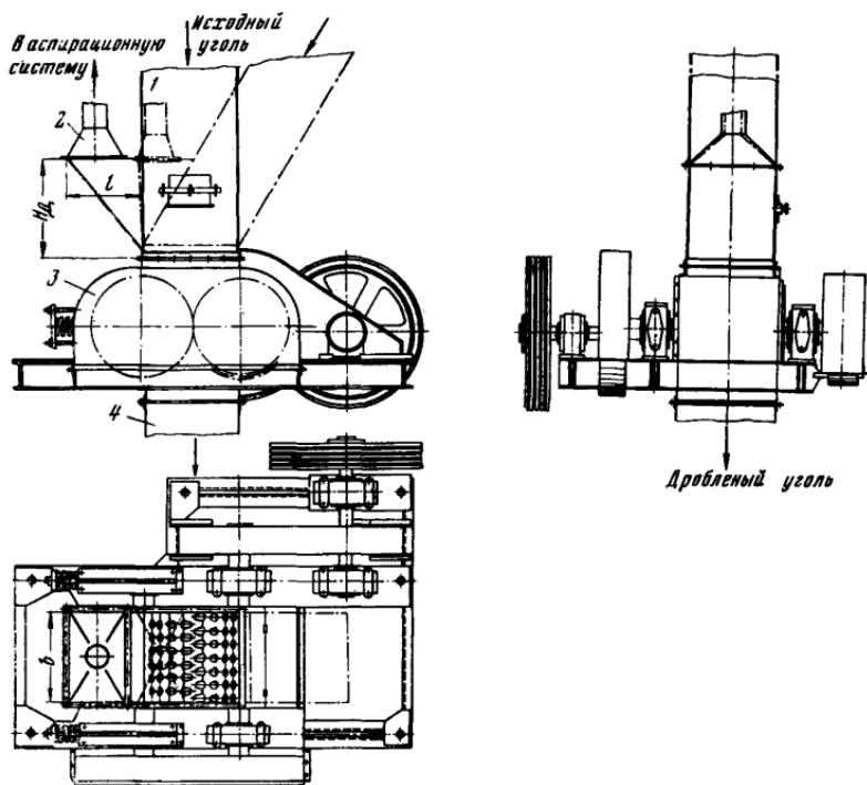
Рис. 14. Укрытие валковой дробилки:
