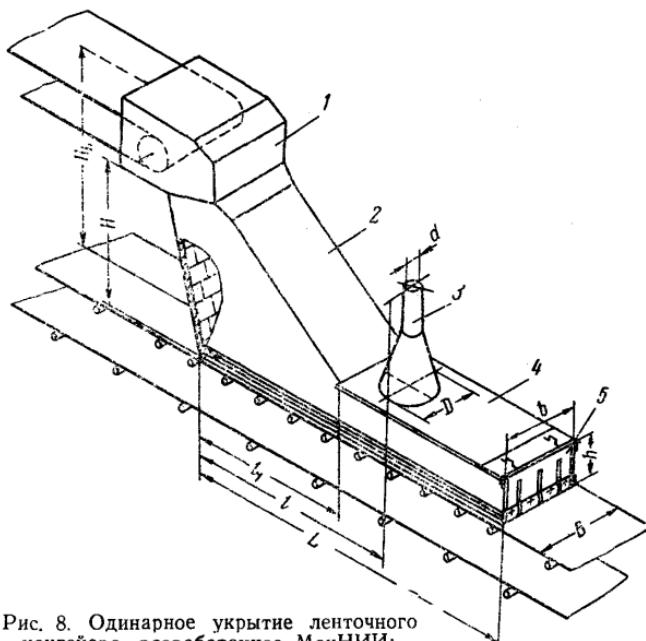
Рис. 8. Одинарное укрытие ленточного конвейера, разработанное МакНИИ:
