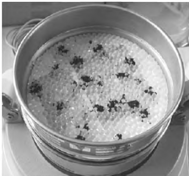
Рисунок 6 — Добавление гранул и загрязняющей смеси
