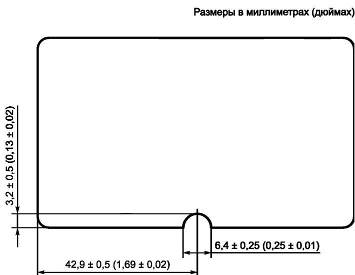
Рисунок 1 — Положение выемки на испытуемой карте
