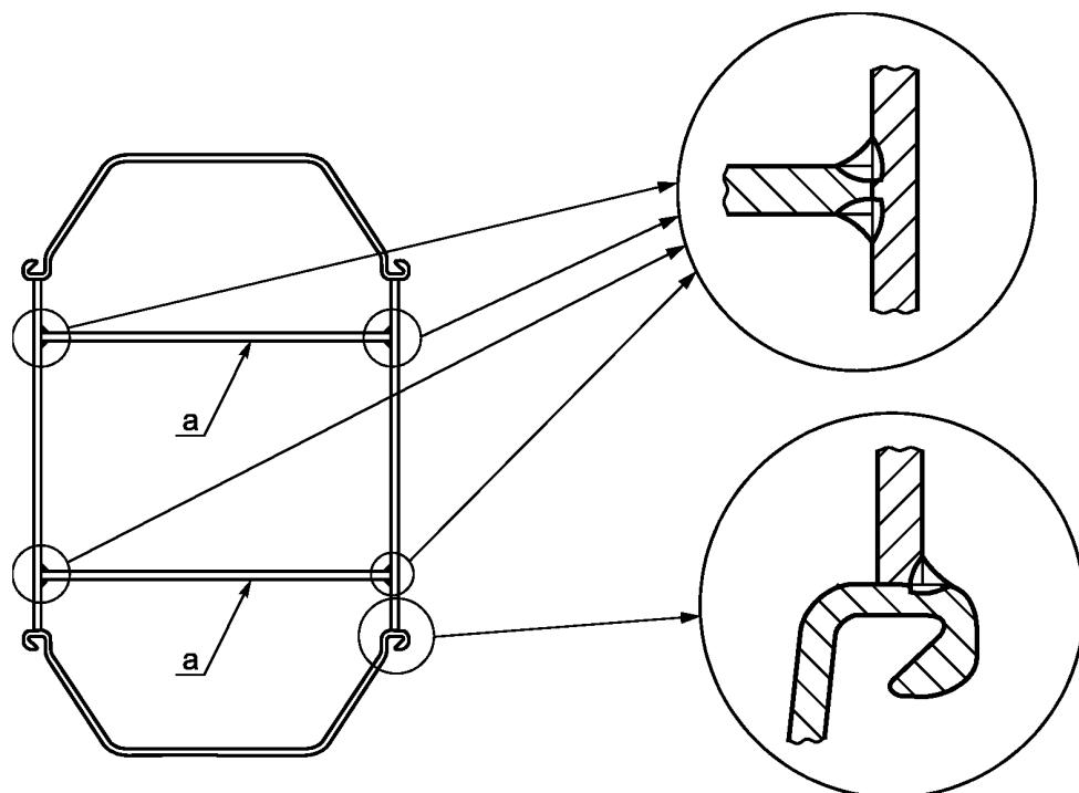
Рисунок 7m — Т-образный стык для свай коробчатого сечения
