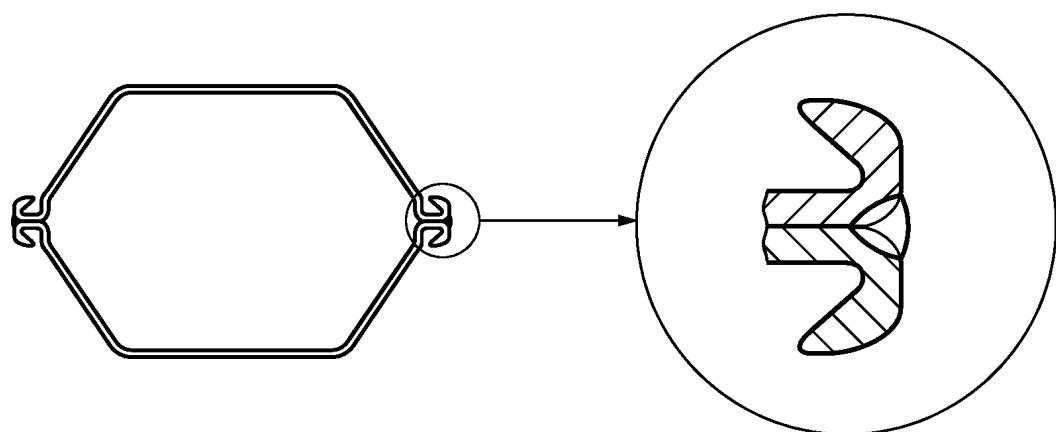
Рисунок 7k — Продольный шов сборных свай коробчатого сечения
