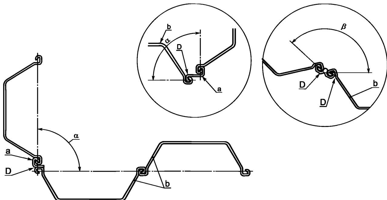
$\alpha$  — угол, составляющий  $\pm 90^\circ$ ;  $\beta$  — угол между  $90^\circ$  и  $135^\circ$ ;
