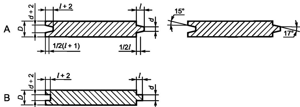
А — шпунт и гребень трапециевидной формы; В — шпунт и гребень прямоугольной формы
