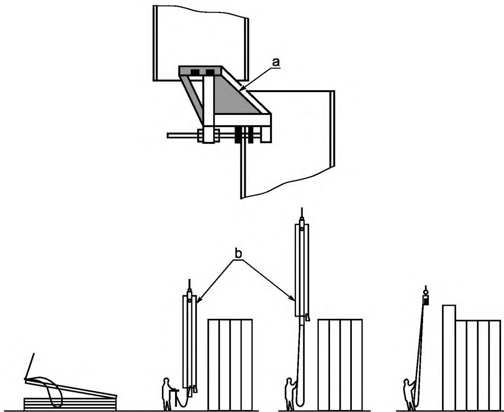
а — приспособление для заведения шпунтовых свай в замок; б — подъем и установка
