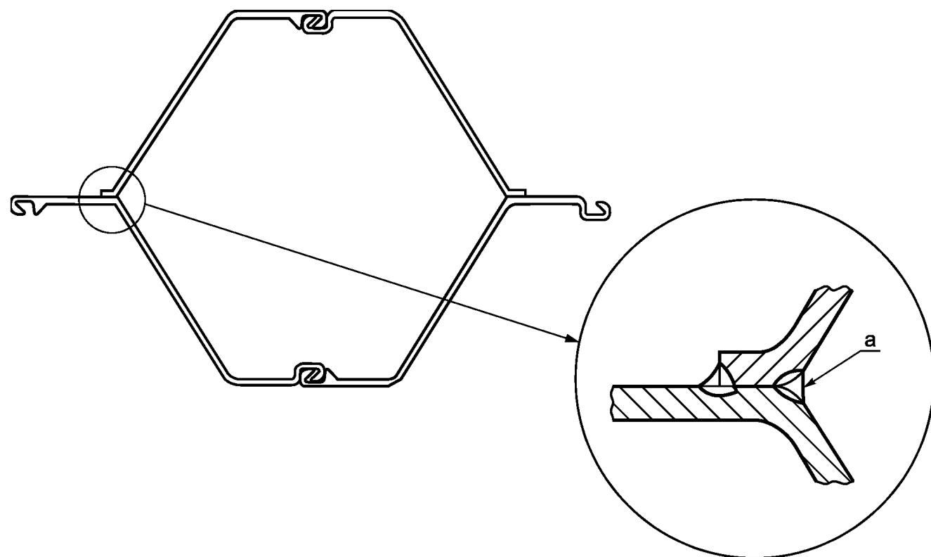
а — внутренний сварной шов (только на длину, составляющую 500 мм на наконечнике и подошве).
