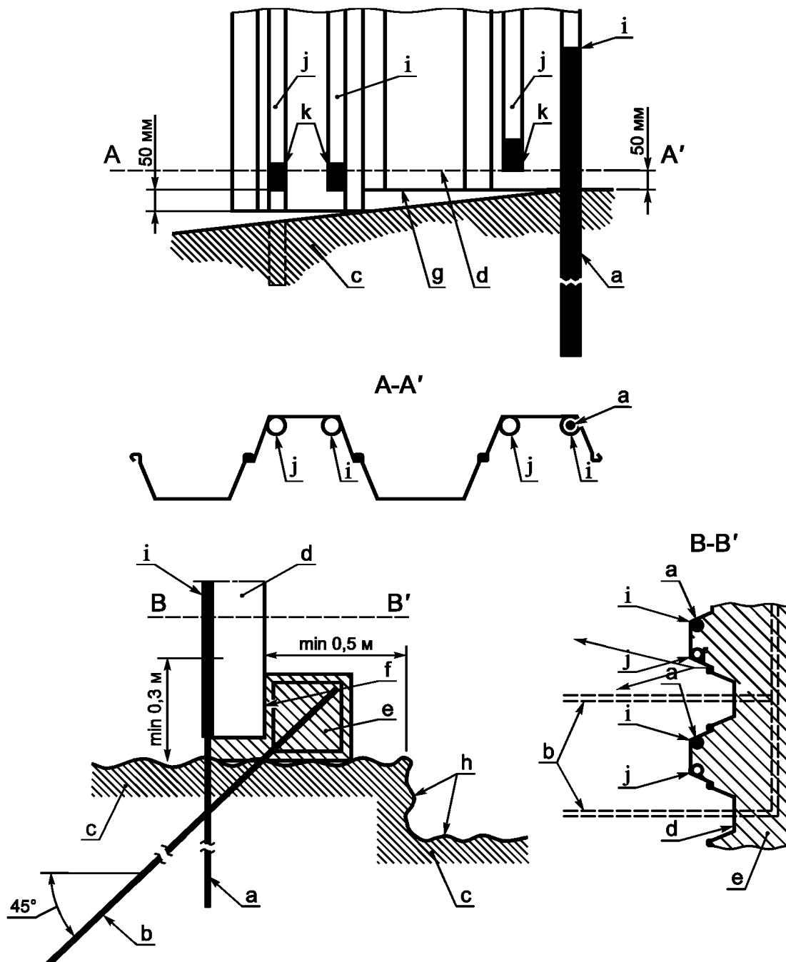
а — скальный дюбель; б — наклонный скальный анкер в случае выемки скальной породы перед шпунтовой стенкой; в — естественная скальная порода; г — шпунтовая свая; е — железобетонная балка; ф — очищенная поверхность; г — глубина подошвы шпунтовой сваи; г — вырытый котлован в скальной породе; и — труба прикреплена в том месте, где ожидается наименьшее расстояние между шпунтовой сваей и скальной породой; ж — резервная труба; к — пробка из бетона, которую следует создать перед установкой
