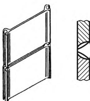
Рисунок 7а — Стыковое соединение удлиненной шпунтовой сваи
