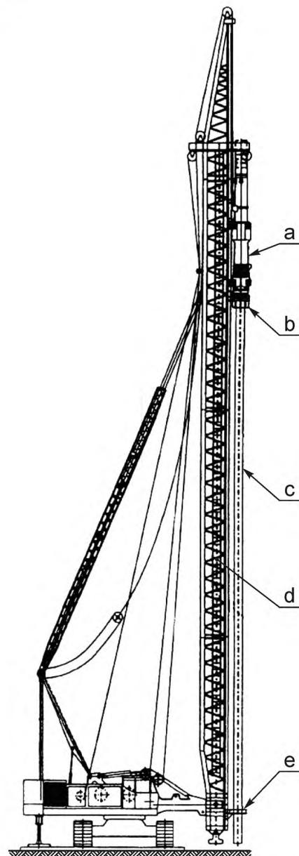
а — молот; б — оголовок шпунта; в — шпунтовая свая; д — направляющая стрела копра; е — нижняя направляющая
