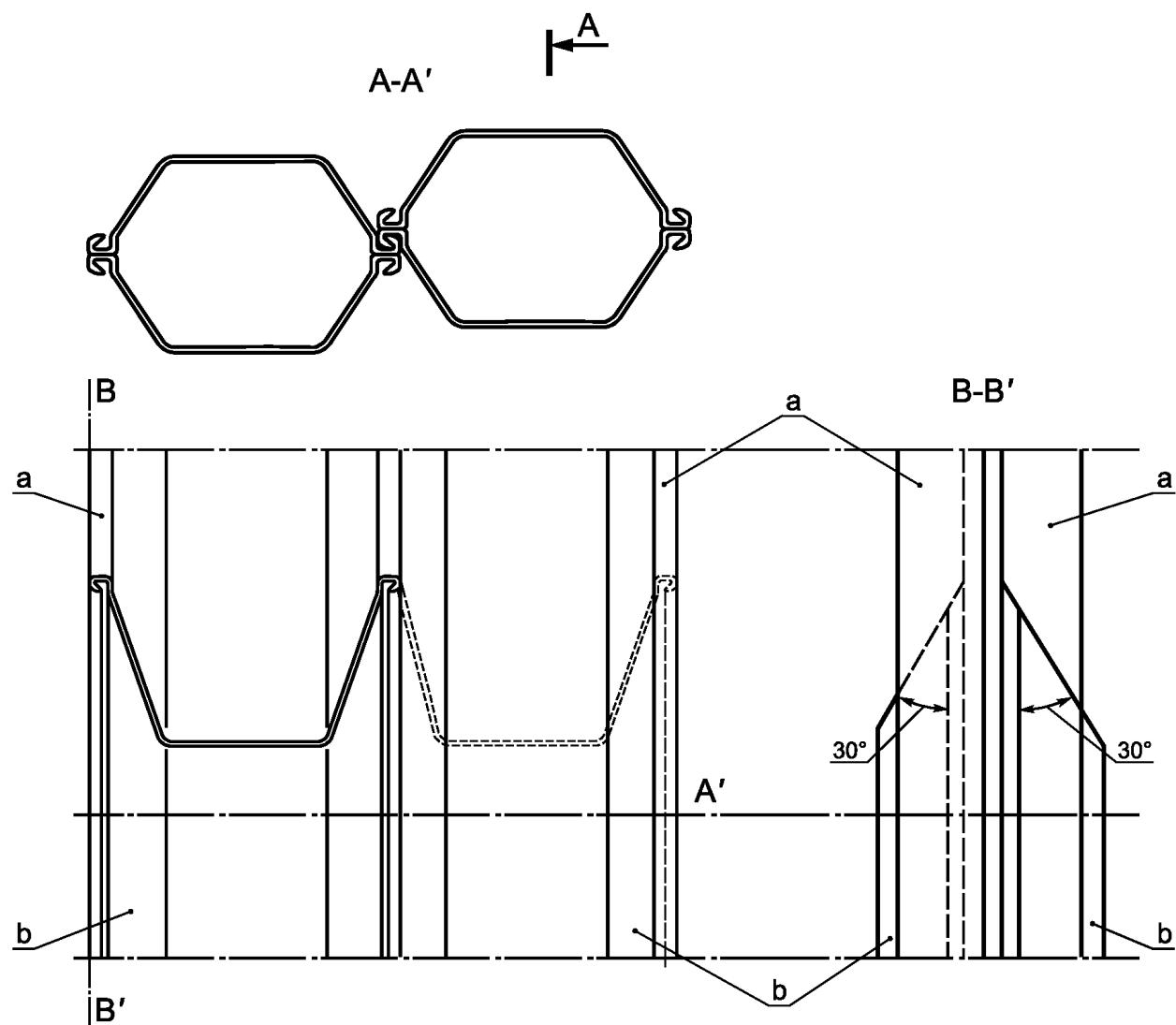
а — усиленная двойная свая; б — скошенный отрезок шпунтовой сваи
