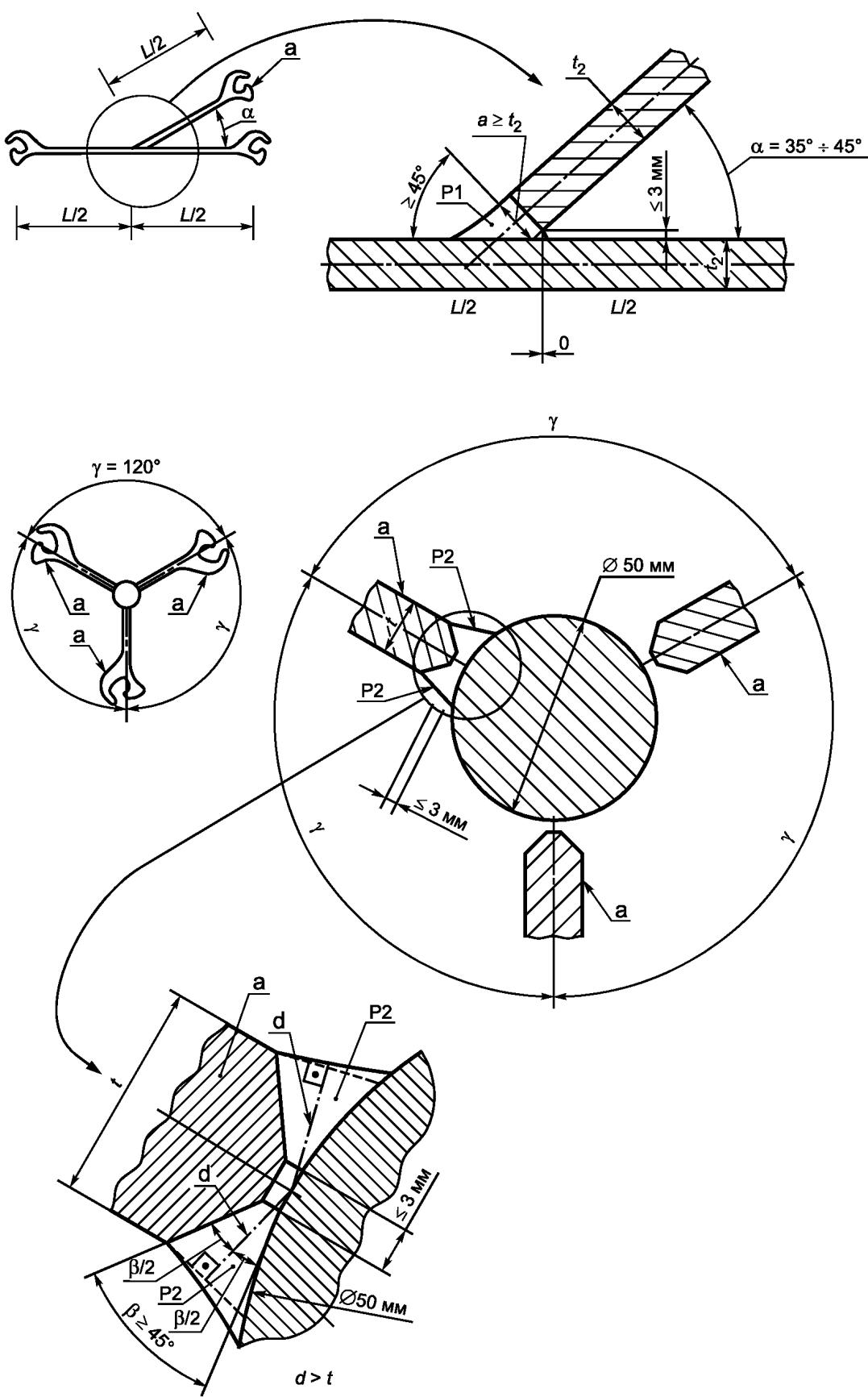
P1 и P2 — сварные швы; а — отрезки для замков
