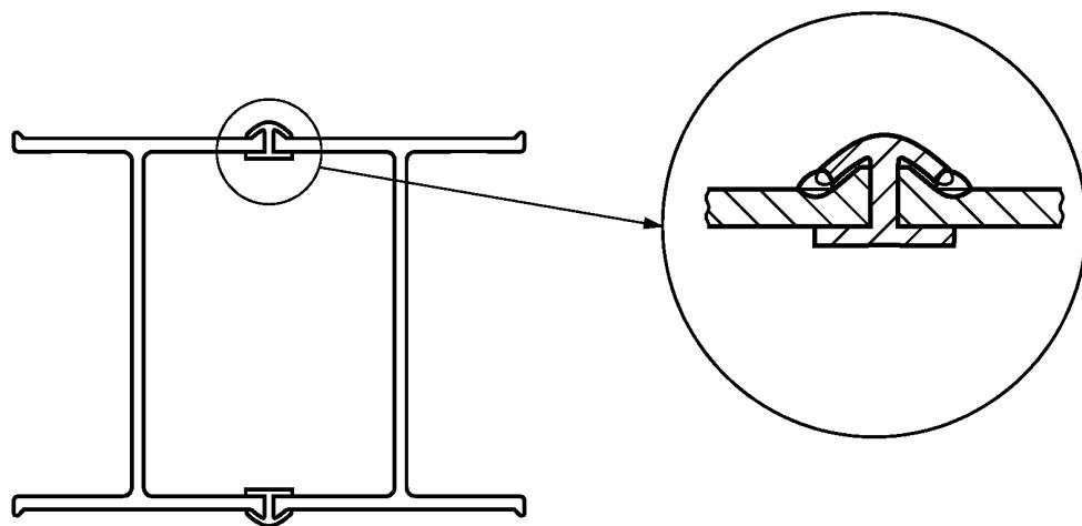
Рисунок 7l — Стык внахлестку для свай коробчатого сечения
