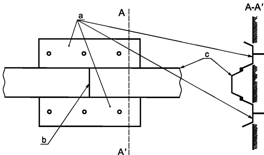
a — протяжной шаблон, закрепленный на опоре; b —стыковое соединение;
