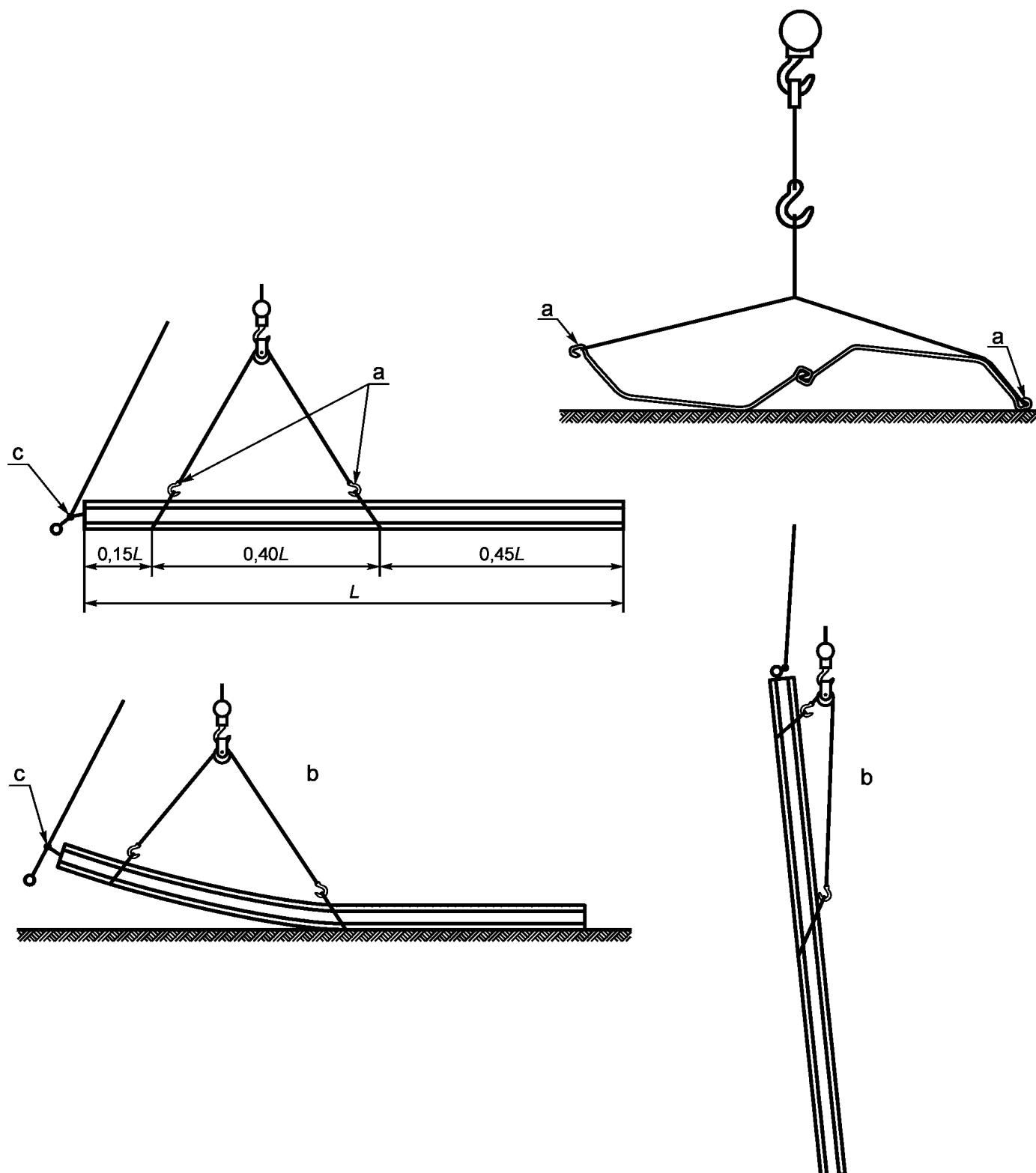
а — места захвата; б — процесс подъема; в — закрепление в системе отверстий шпунтовой сваи
