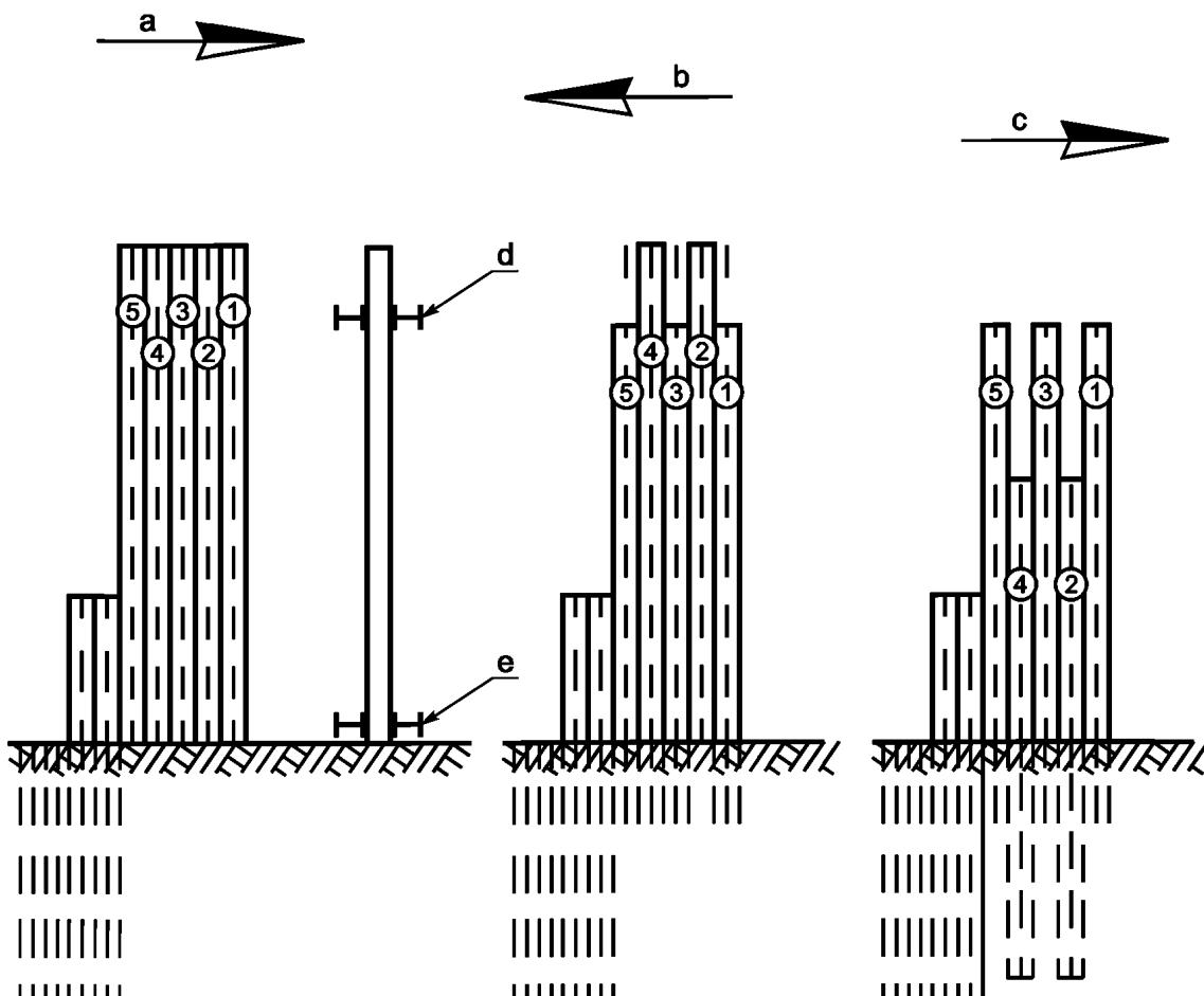
а — направление заведения; б — направление установки (1, 3, 5); в — направление установки (4, 2);
