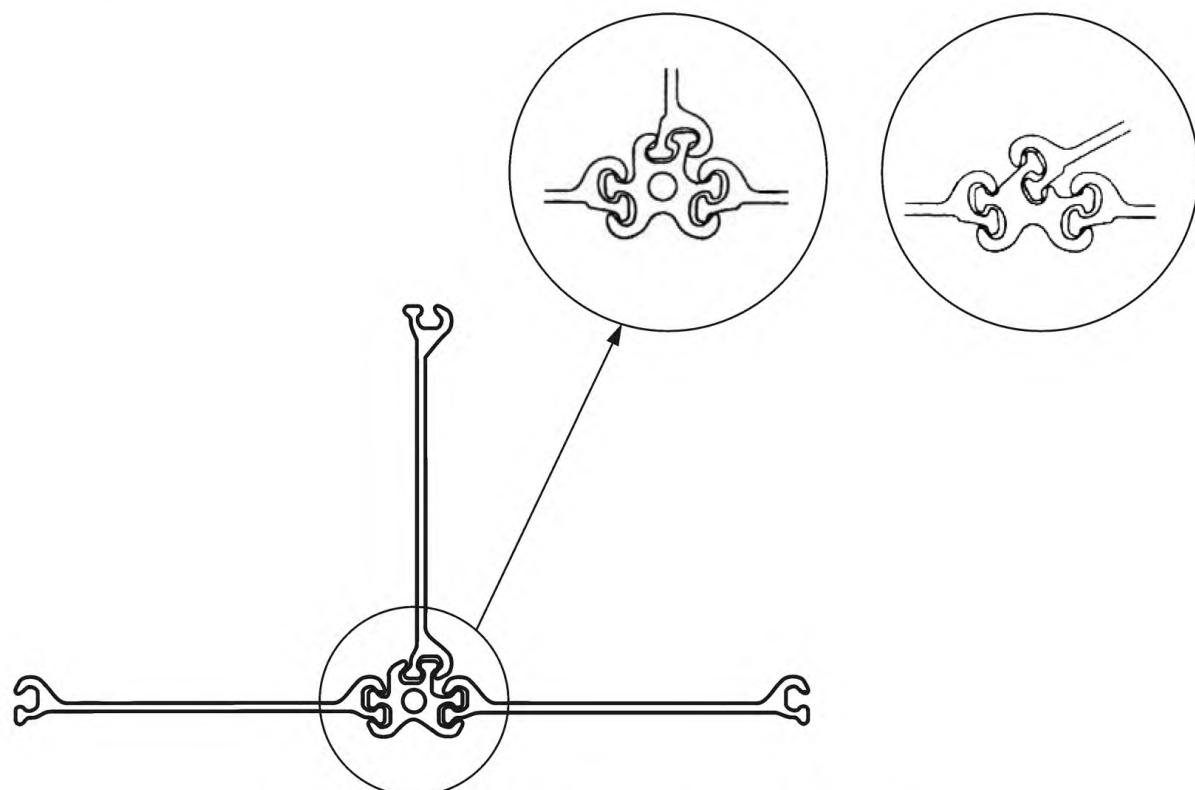
Рисунок В.6 — Соединительная свая из плоских профилей:
