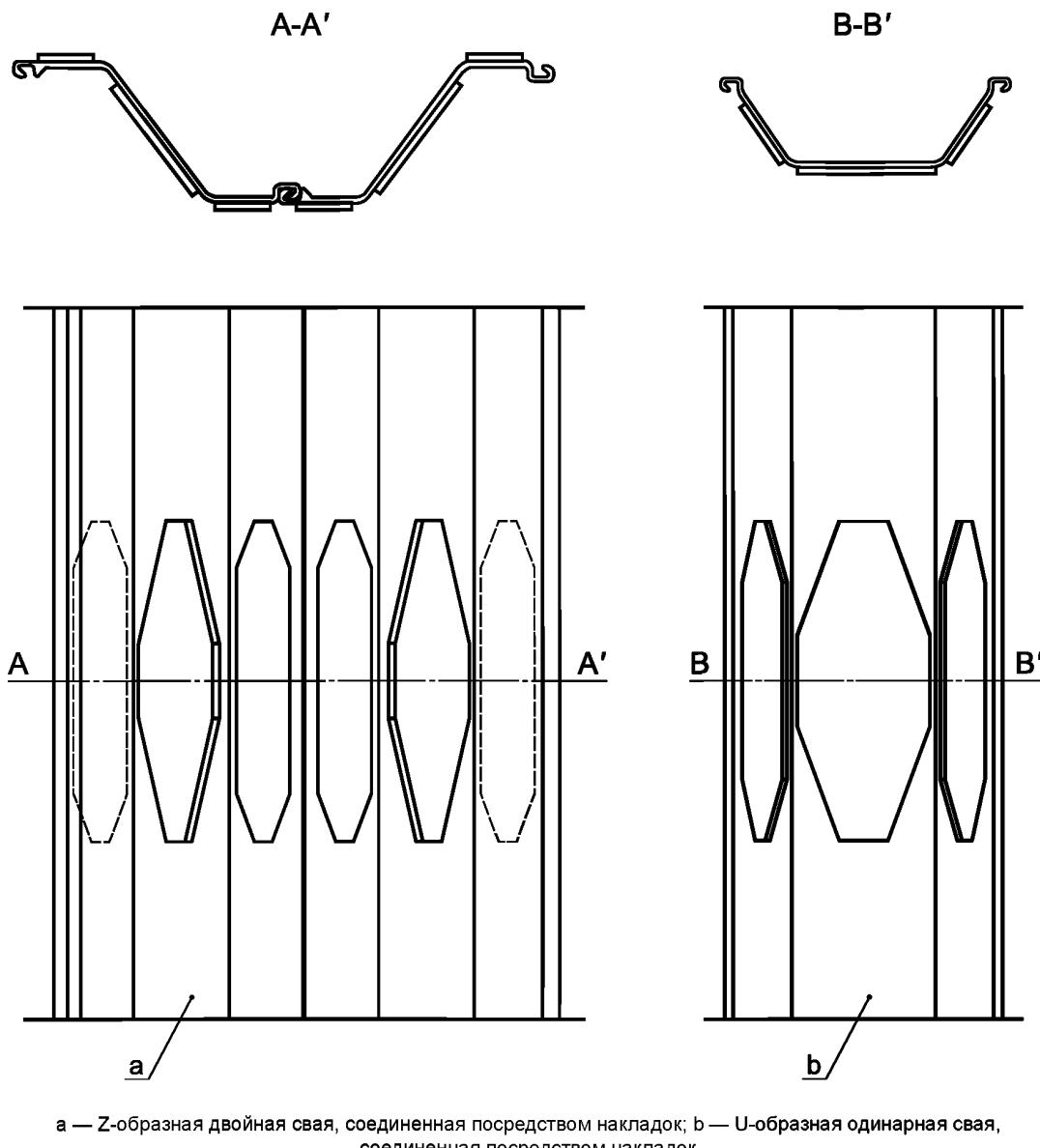
а — Z-образная двойная свая, соединенная посредством накладок; б — U-образная одинарная свая, соединенная посредством накладок
