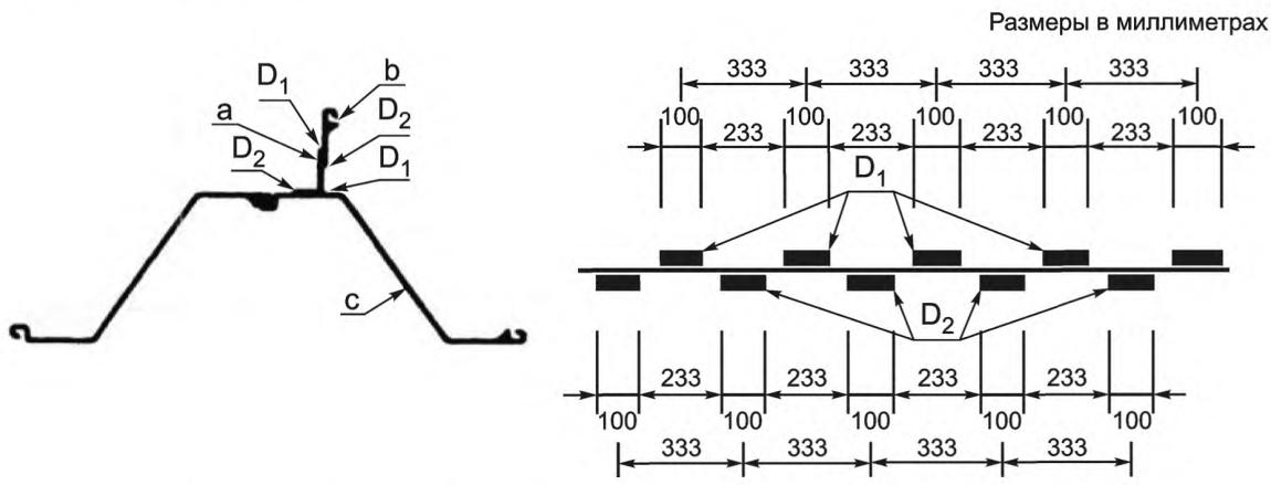
D<sub>1</sub> и D<sub>2</sub> — сварные швы; a — стальной уголок; b — отрезок для замка; c — Z-образная двойная свая;
