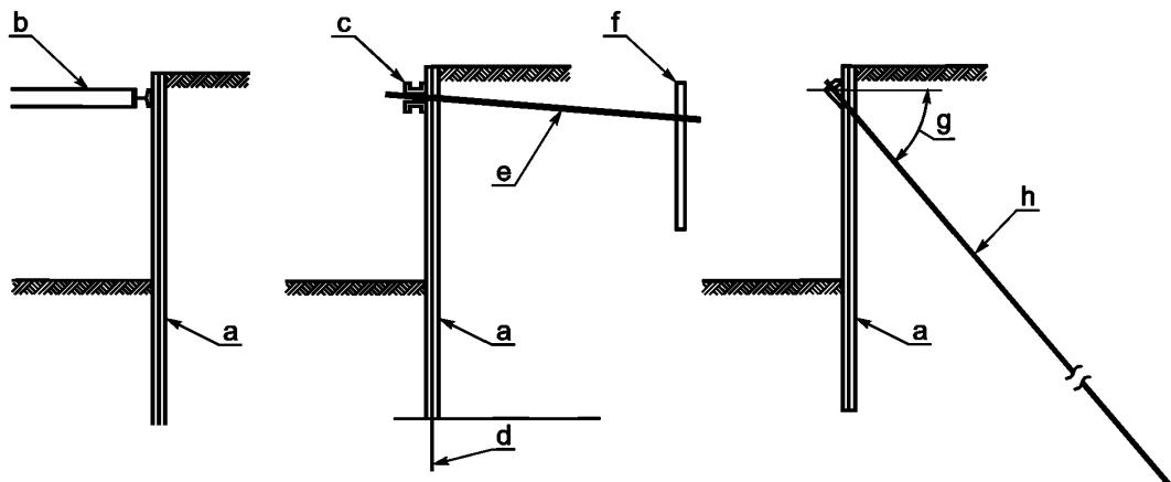
а — шпунтовая свая; б — жесткий элемент; в — пояс; д — скальный дюбель; е — стержень анкера; ф — анкерная плита или анкерная стенка; г — переменный угол; х — запрессовываемый анкер или свая, работающая на растяжение
