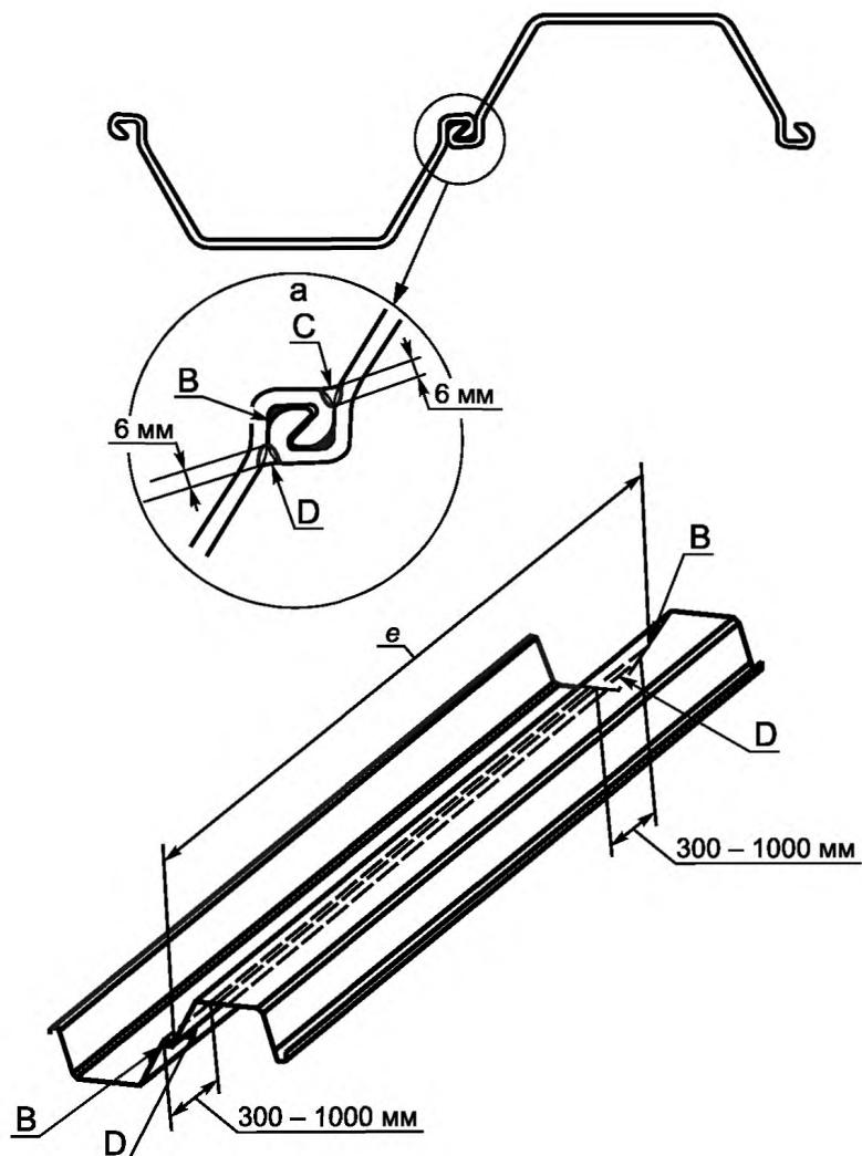
В — лабиринтный сварной шов в верхней и нижней части шпунтовой сваи; С — основной сварной шов;
