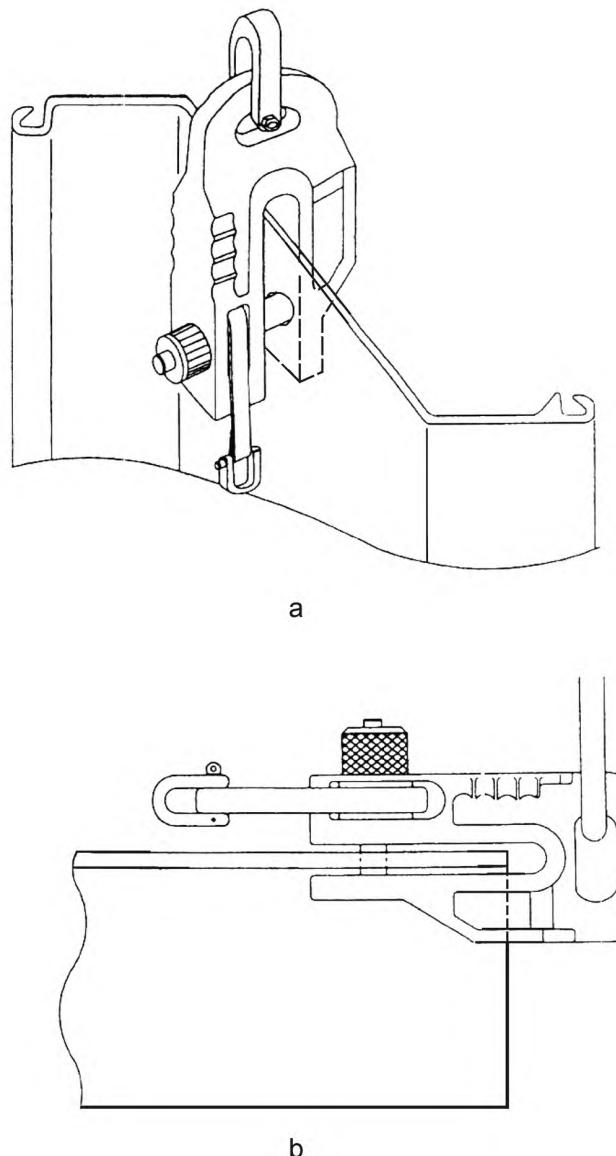
а — осевой подъем; б — подъем под углом 90° к оси шпунтовой сваи
