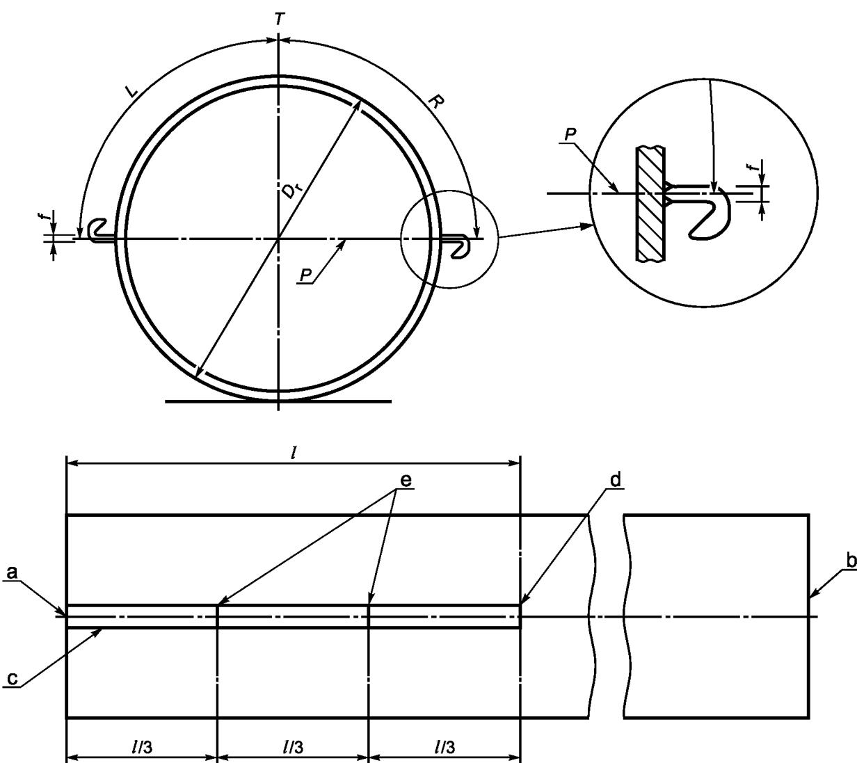
а — верхняя часть наконечника несущего элемента и замковых профилей; б — нижняя часть подошвы несущего элемента; в — замковые профили; г — подошва замковых профилей; е — точка трети замковых профилей; ф — длина замковых профилей; г — вертикальная линия трубообразного несущего элемента, которая устанавливается посредством нивелировки;  $h$  — линия, которая соединяет середину обоих замковых профилей в верхней части наконечника несущего элемента
