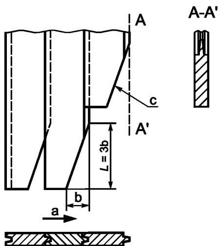
а — направление установки; б — ширина снятой фаски; в — направление давления грунта
