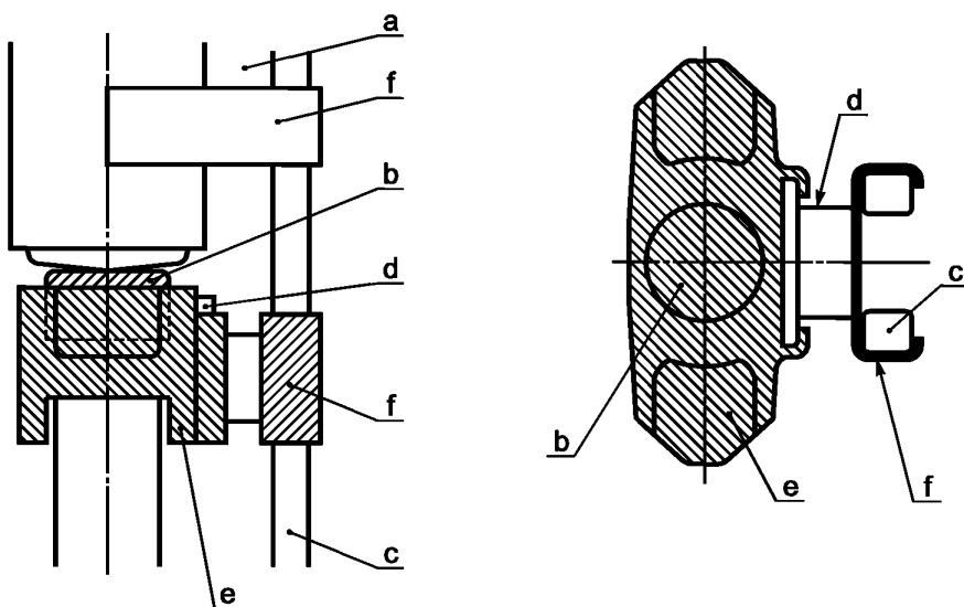
а — молот; б — амортизирующая прокладка оголовка шпунта; в — направляющая стрела копра;
