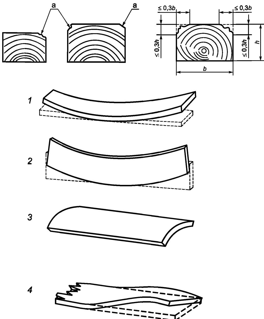
(1) — продольная кривизна широкой стороны; (2) — продольная кривизна узкой стороны; (3) — поперечная кривизна;
