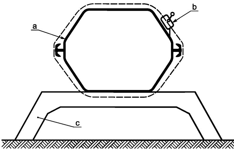
а — свая коробчатого сечения из U-образных свай; б — цепная тяга;
