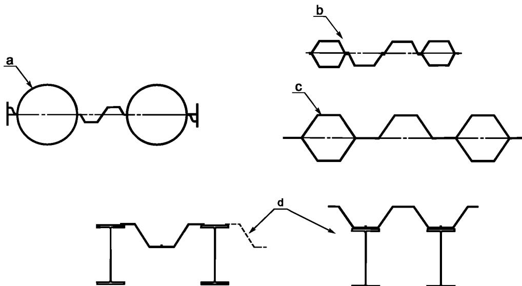
а — трубы + U-образные шпунтовые сваи; б — сваи коробчатого сечения из U-образных сваи + U-образные шпунтовые сваи;
