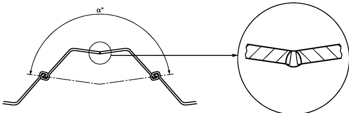
Рисунок 7h — Угловой стык примыкающей, угловой и соединительной свай
