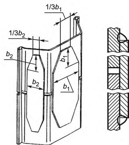
Рисунок 7д — Замок со стыковой накладкой жесткой на изгиб шпунтовой сваи
