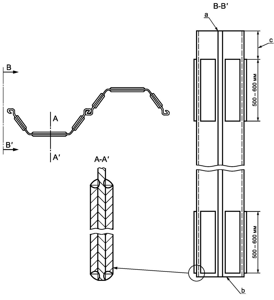
Рисунок 10 — Пример простого усиления верхней и нижней частей У-образной двойной шпунтовой сваи
