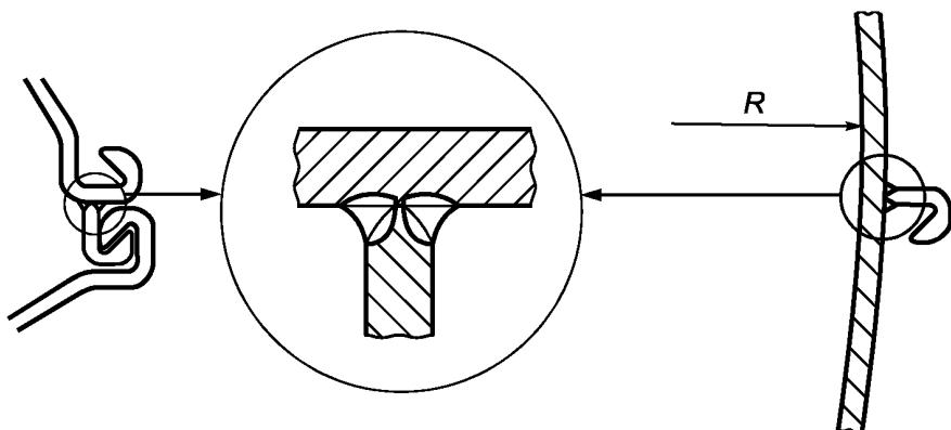
Рисунок 7g — Т-образный стык примыкающей, угловой и соединительной свай
