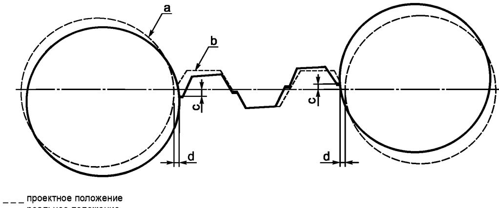
а — первичный элемент; б — вторичный элемент; с — поперечное отклонение; д — продольное отклонение
