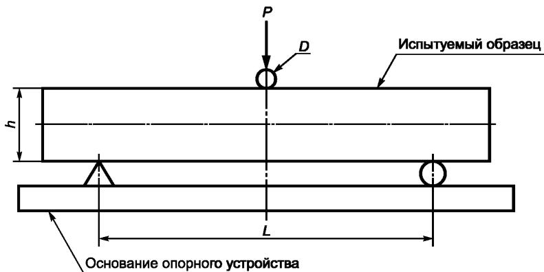
$h$  — высота испытуемого образца, см;  $L$  — расстояние между опорами, см;  $D$  — диаметр металлического стержня, мм;
