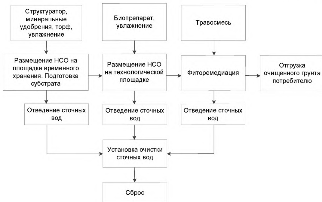
Рисунок 2.5 — Технологическая схема процесса утилизации и обезвреживания НСО биологическими методами
