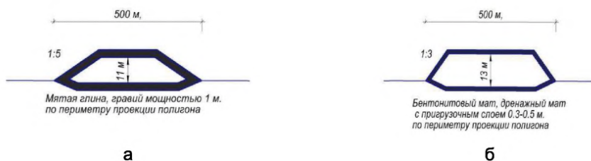
Рис. 2.3 — Устройство ПФЭ из глинистых материалов (а) и из бентонитовых матов (б) ([28])
