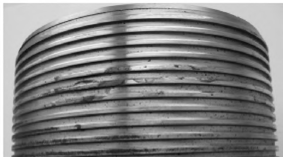
а) Следы коррозии на наружной резьбе
