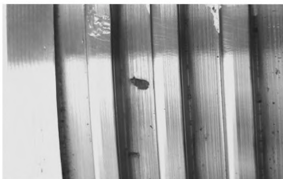
б) Раковина, образовавшаяся на наружной резьбе после выпадения крупного неметаллического включения
