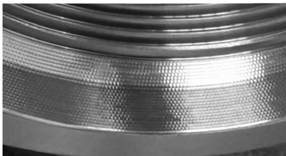
б) Следы вибрации, приводящие к несоответствию геометрических параметров расточки и заходной фаски
