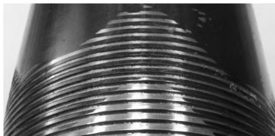
а) Прерванные витки на наружной резьбе с неполным профилем
