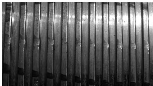
б) Задир на наружной резьбе после перемещения изделия
