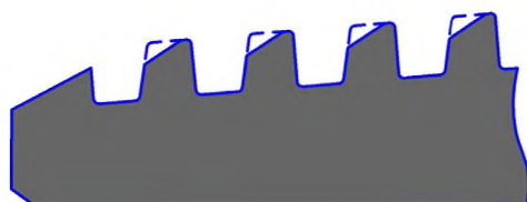
д) Подрез вершины витка резьбы
