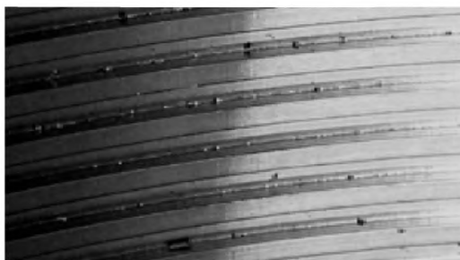
а) Задир на внутренней резьбе после нарезания резьбы
