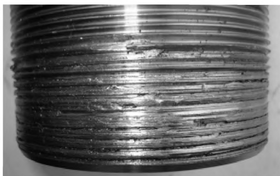
Рисунок 16 — Сорванные витки наружной резьбы
