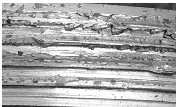
б) Рванины на витках наружной резьбы
