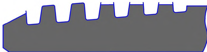
а) Гребни на заходной фаске и вершинах витков наружной резьбы с неполным профилем
