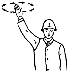
Рис. 2. Правая рука поднята вверх, полусогнута, плечо горизонтально, предплечье в вертикальном положении «Поднять медленно» — кисть руки вращать по часовой стрелке; «Поднять быстро» — рукой до локтя вращать по часовой стрелке
