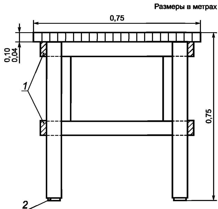
1 — ножки и стяжки, склеенные и скрепленные шурупами; 2 — изолирующие прокладки
