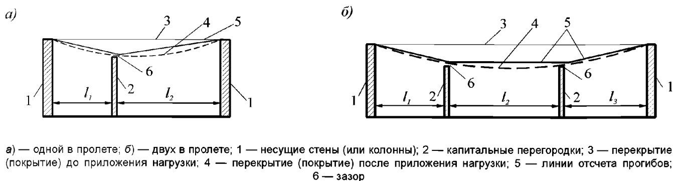
Рисунок Д.1 — Схемы для определения значений l ( l_1 , l_2 , l_3 ) при наличии между стенами капитальных перегородок
