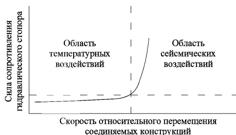
Рисунок А.9 — Схема работы гидравлического стопора
