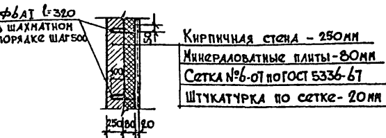
ДЕТАЛЬ УТЕПЛЕНИЯ СТЕН ВЕНТКАМЕРЫ
