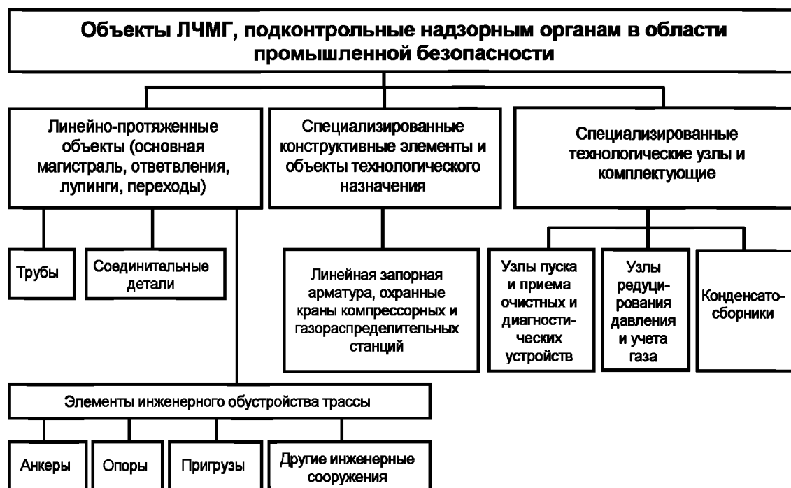
Рисунок 1 — Схема декомпозиции объектов ЛЧМГ с выделением элементов для оценки срока службы (ресурса) и назначения срока безопасной эксплуатации
