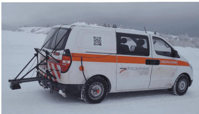
Рисунок 2 – Измерение толщины льда на ледовой переправе бесконтактным антенным блоком АБ-1700Р
