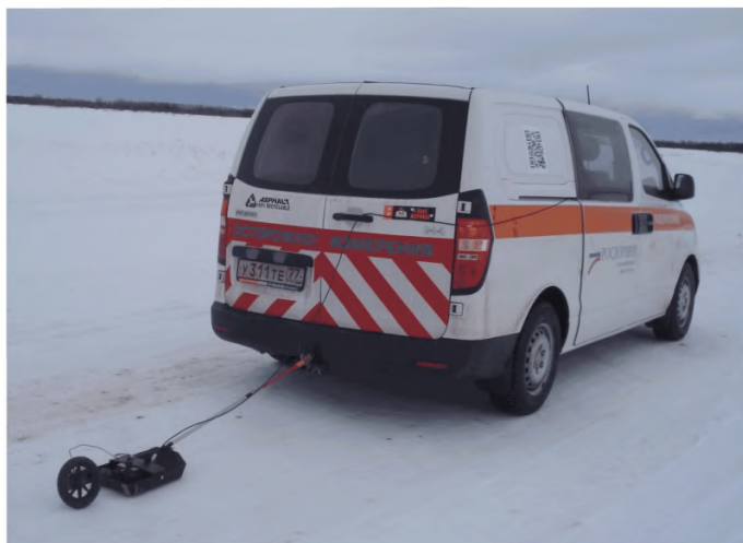
Рисунок 1 – Измерение толщины льда на ледовой переправе контактными антенными блоком АБ-1700
