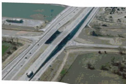
Рисунок В.2 - Кольцевая организация движения под эстакадой на второстепенном направлении [7]
