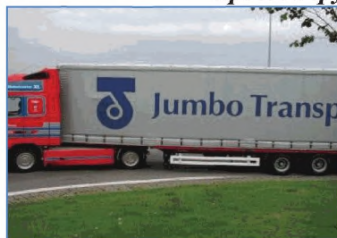
Рисунок 5.6 - Проезд кольцевых пересечений с заездом на краевую полосу центрального островка крупногабаритным грузовым автомобилем [7]
