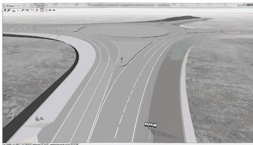
Рисунок А.9 – 3D-вид кольцевого пересечения (цифровая модель)
