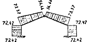
Рис. 6.9. Расчетная схема рамы, схемы загрузки и эпюры M , N и Q при постоянной (а), снеговой (б) и ветровой (в) нагрузках, соответственно кНм, кН
