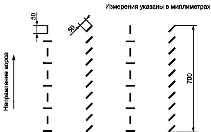
Рисунок 7 — Расположение нитей в испытании по удалению нити
