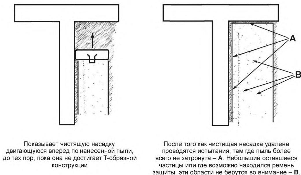
Рисунок 2 — Определение убранной области
