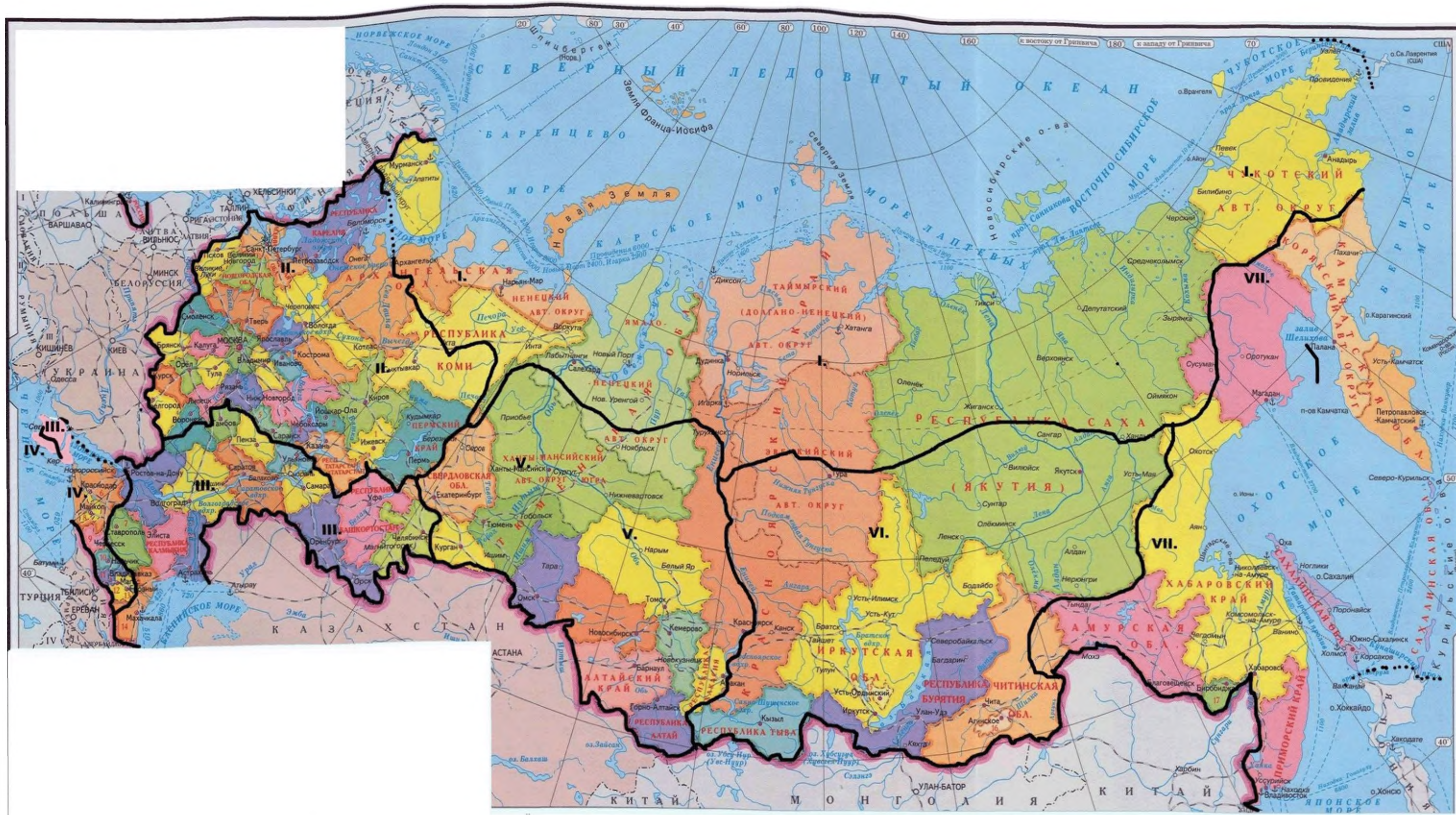
Рисунок 1 – Агроландшафтное районирование территории России для оптимального подбора видов и сортов трав для укрепления откосов земляного полотна автомобильных дорог
