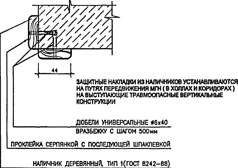
УСТАНОВКА ЗАЩИТНЫХ НАКЛАДОК НА ВЫСТУПАЮЩИХ КОНСТРУКТИВНЫХ ЭЛЕМЕНТАХ
