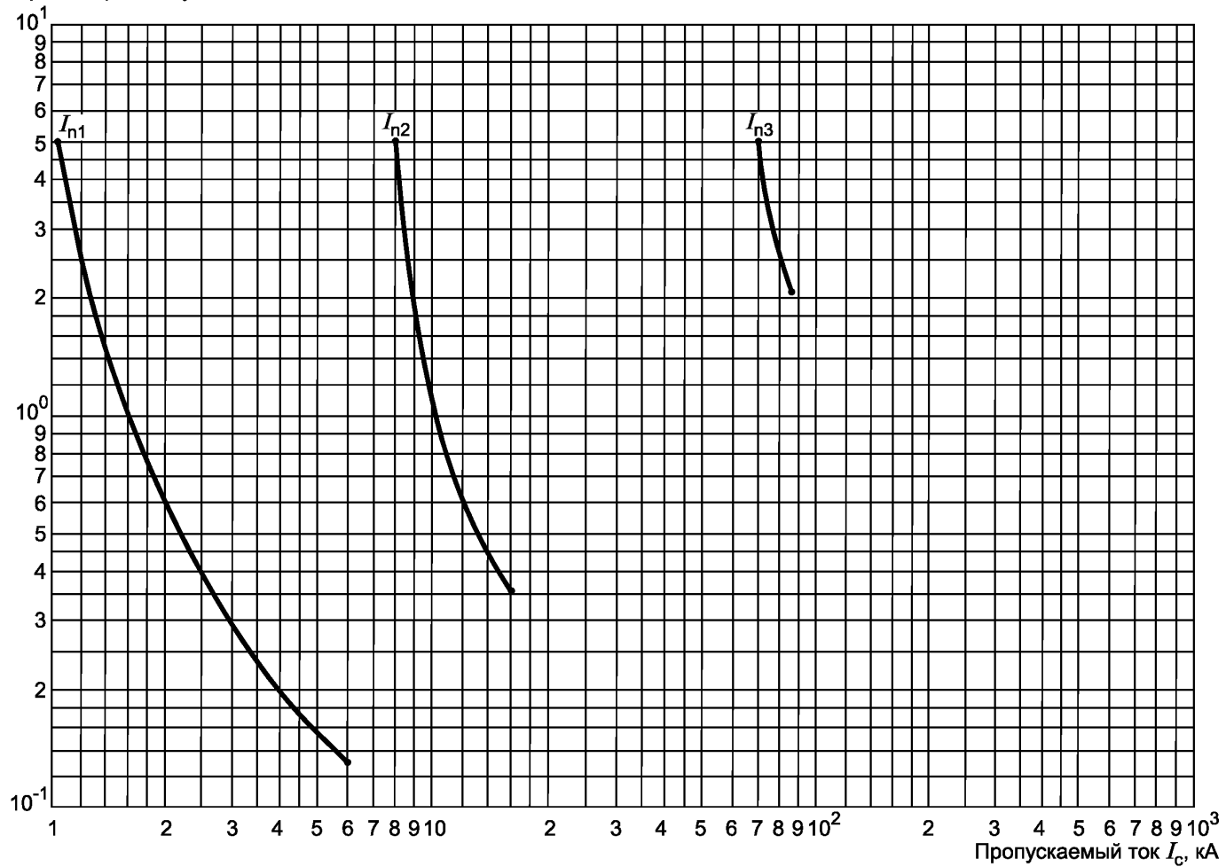
Рисунок С.1 — Характеристика пропускаемого тока в зависимости от времени горения дуги
