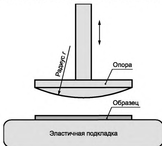
Рисунок 7 — Схема испытательного стенда для воздействия комбинированной нагрузки сжатия и изгиба («ношение в заднем кармане брюк»)
